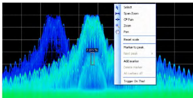
革命性的 DPX® 频谱显示揭示了瞬变信号过程，帮助您发现不稳定性、毛刺和干扰信号。在这里，能够清楚看到 3 个信号。两个大信号，由于出现概率不同，一个深蓝色，一个浅蓝色。第三个信号隐藏在中心频率里面，但是仍然可以被清楚的看到。DPX Density™ 触发，在存在第三个信号时，用户可以采集信号进行分析。Trigger On This™ 已被激活，密度测量框自动被打开，测得信号密度为 7.275%。任何信号密度大于该测量值的信号都会导致触发事件发生。
