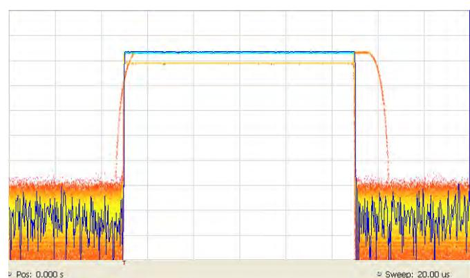
DPX 零频宽（Zero-Bandwidth）实现了幅度、频率、相位对时间的实时分析。高达 50,000 次/秒处理速度。DPX 零频宽（Zero-Bandwidth）保证了时域瞬态信号的发现，减少了调试时间。上图，在时域幅度对时间中捕获了三个不同的脉冲。其中两个波形只是 10,000 个脉冲才出现一次，但是通过 DPX 都能显示和捕获。
