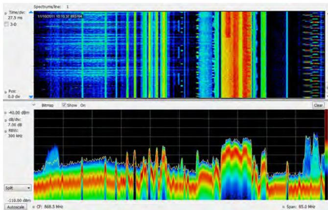
DPX 三维频谱图可以一次无隙监测多天的频谱。可以记录和复核 60000 条轨迹，每行分辨率可以从 125 微秒到 6400 秒调节。
