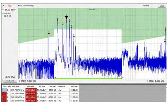
杂散信号搜索 – 最多可定义 20 个非连续频率区域，每个区域有其自己的解析带宽、视频带宽、检波器（峰值、平均值、准峰值）及极限范围。测试结果可以用 CSV 格式导出到外部程序，最多可报告 999 个杂散点。频谱结果显示可采用线性或对数标度。
