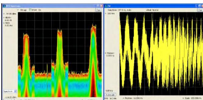
音频监测和调制度测量可以同时进行，使频谱管理更加简便和高效。上图，DPX 频谱显示了关心信号的实时频谱，同时，音频解调结果从内扬声器输出。并且，在图右中同时得到了 FM 频偏测量结果。
