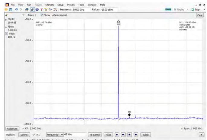
宽带宽、高动态范围选项(B85HD、B125HD 和 B16xHD)提供了无可比拟的实时频谱分析动态范围。隔行扫描两个 16 位 200MS/s 数字化器，得到 400 MS/s 采集及 -80dBc 的典型无杂散动态范围，要优于其他商用仪器 10 dB。这里测得 3 GHz 处的信号电平为 -13.71dBm，来自数字化器的最大杂散信号要比载波低 -87.89dB。
