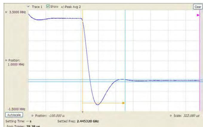
稳定时间测量（选项 12）非常简单且自动完成。用户可以选择测量带宽、容限频段、参考频率（自动或手动），为通过/失败测试稳定最多三个容限频段。稳定时间可以以外部或内部触发做为参考点，也可以从上次稳定频率或相位开始计算。上图通过外部触发测量了振荡器跳频的频率稳定时间。
