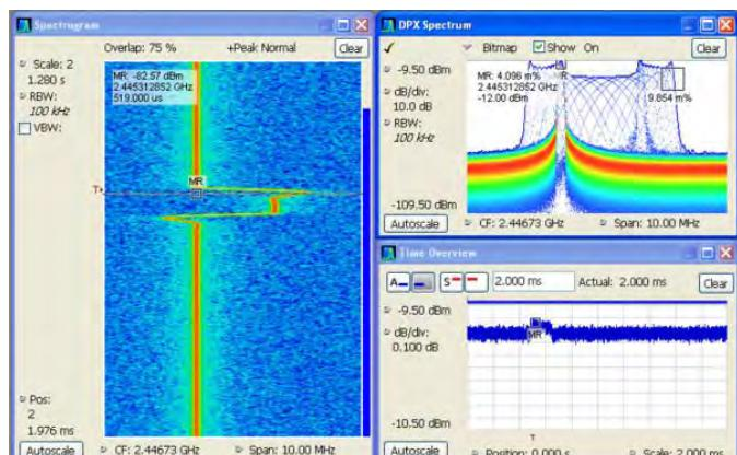
**触发和捕获：**DPX密度触发(DPX Density™)功能监测频域中的变化，并把任何超限信号捕获到存储器中。三维频谱图(左窗格)显示了频率和幅度随时间变化情况。通过在三维频谱图中选择频谱超限触发 DPX 密度™ 触发功能的时点，频域画面(右窗格)会自动更新，及时显示该精确时刻的详细频谱视图。
