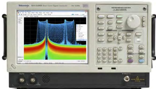
RSA5000系列实时信号分析仪代替了传统仪器，为您完成日常任务提供了所需的测量信心和功能。RSA5100B系列提供了行业领先的实时指标，包括100%检测概率最短的最短信号持续时间及最好的实时动态范围。通过RSA5000系列仪器，您可以在一台仪器中同时获得高性能频谱分析仪功能、宽带矢量信号分析仪功能以及实时频谱分析仪独特的触发、捕获、分析功能。
