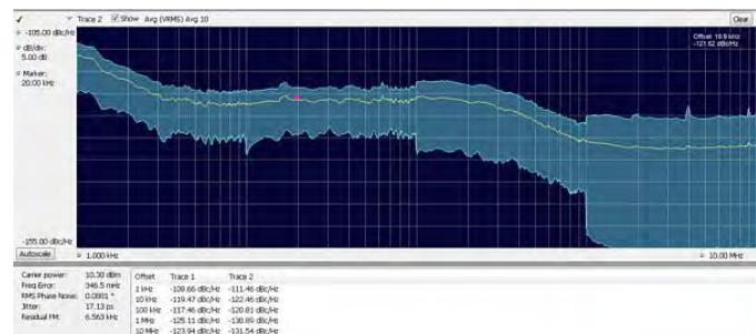
RSA5000 系列上的相位噪声和抖动测量（选项 11）可取代专业相噪测试仪，为您节省测量成本。出色的相噪性能能够满足许多应用需求。上图，在 13 MHz 载频，偏置 10kHz 下相噪为 -119 dBc/Hz，在这个频率，仪器相噪能够达到 -134 dBc/Hz。
