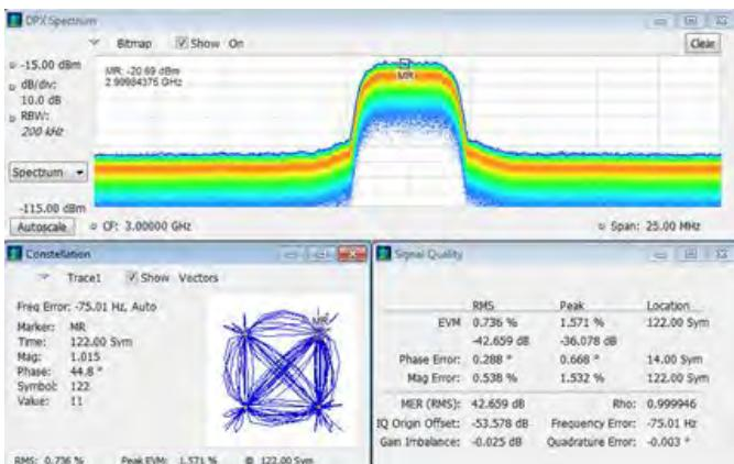
时间相关的多域观测视图使得发现设计或运行问题的能力达到了新的水平，这是使用常规分析仪解决方案不可能做到的。上图，调制质量和星座测量与 DPX® 频谱显示技术的连续监测结合在一起。
