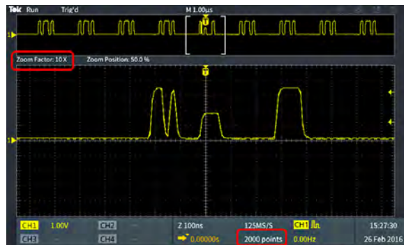
最大缩放波形记录捕获了 2000 个点
