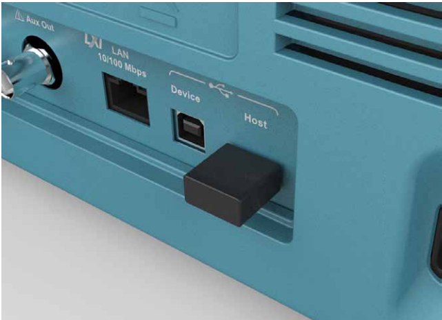
Wi-Fi 适配器通过集成设置菜单配置，支持无缝通信。
