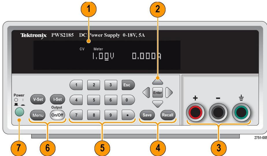
1. 包含设置或者电压（左）/电流（右）输出相关信息的显示器
