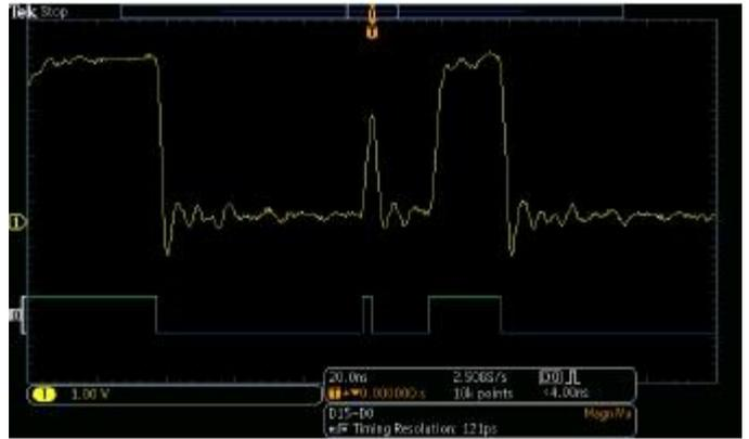
MagniVu 超高分辨率记录提供 121.2 ps 的定时分辨率，可以在数字波形上进行重要的定时测量。
