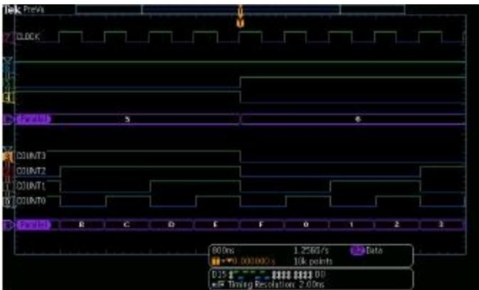
通过颜色编码的数字波形显示，只需在屏幕上将数字通道放在一起即可进行分组，然后按组移动数字通道。
