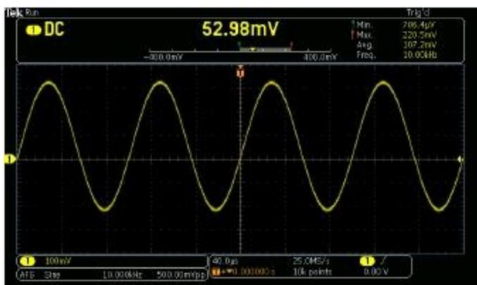
显示直流测试，包括 5 秒时间变化内的最大值、最小值和平均电压值。同时显示波形的频率。
