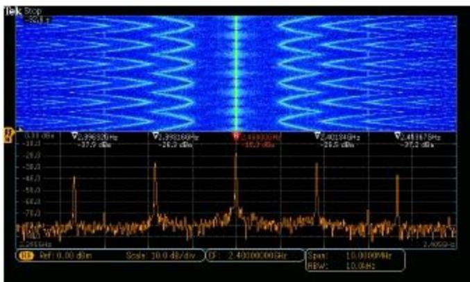
三维频谱图显示画面显示出缓慢移动的射频现象。此处所示的是正在监视具有多个峰值的信号的情形。由于峰值的频率和幅度都会在时间上发生变化，从三维频谱图显示屏上可以方便地看出这种变化。
