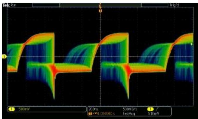
带有 FastAcq 的数字荧光技术可以实现 > 280,000 wfm/s 的波形捕获速率和实时颜色辉度等级。
