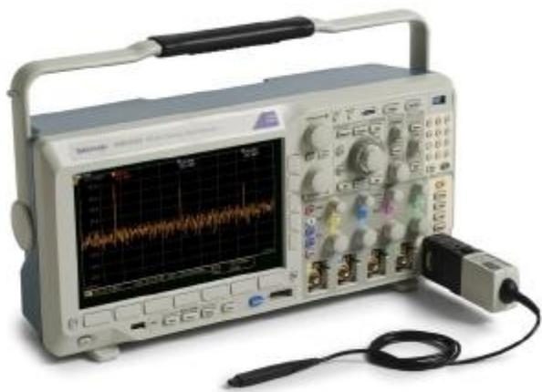
选配 TPA-N-VPI 适配器可以在射频输入上连接任何有源的 50  $\Omega$  TekVPI 探头。
