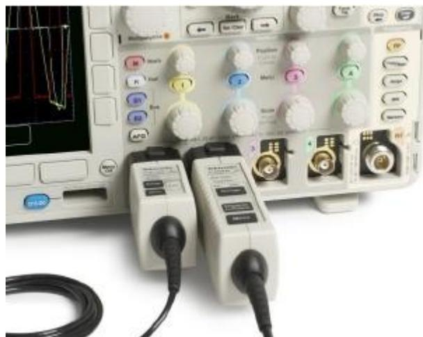
TekVPI 探头接口简化了探头与示波器的连接。
