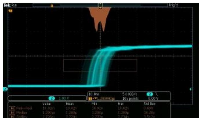
上升沿的波形直方图显示边沿位置(抖动)随时间的分布,包括在波形直方图数据上进行的数字测量。
