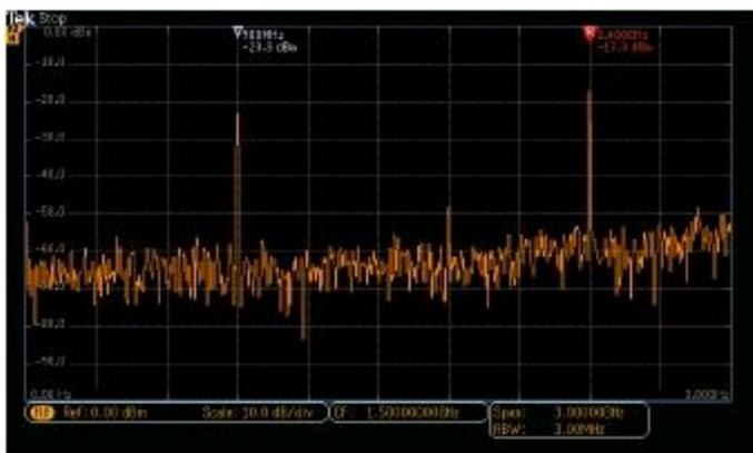
无论是通过 Zigbee 以 900 MHz 频率与器件进行的突发通信，还是通过蓝牙以 2.4 GHz 频率从器件发出突发通信，均可在一次采集捕获突发通信的频谱显示。
