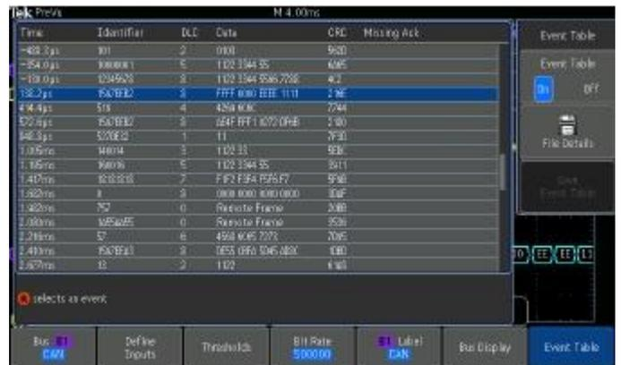
事件表显示长采集中每个 CAN 包解码的标识符、DLC、DATA 和 CRC。
