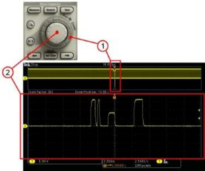
Wave Inspector 控件在查看、导航和分析波形数据方面提供了前所未有的效率。通过旋转外环的卷动控件 (1)，可以迅速浏览长记录。从头到尾仅需几秒钟，即可找到详细信息。找到关心的部分，还要查看更多细节？只需旋转内环的缩放控件 (2)。
