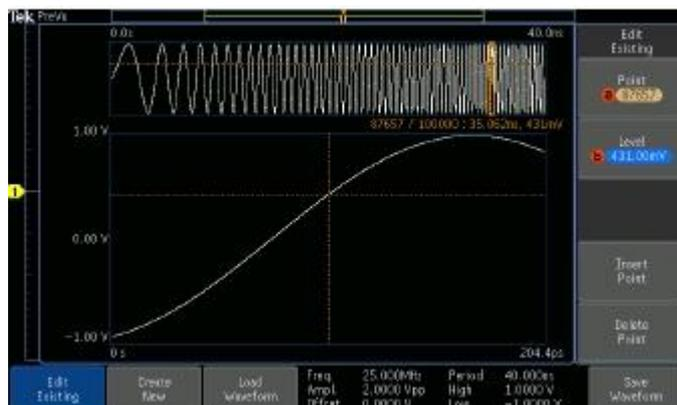
显示点到点编辑的任意波形编辑器。
