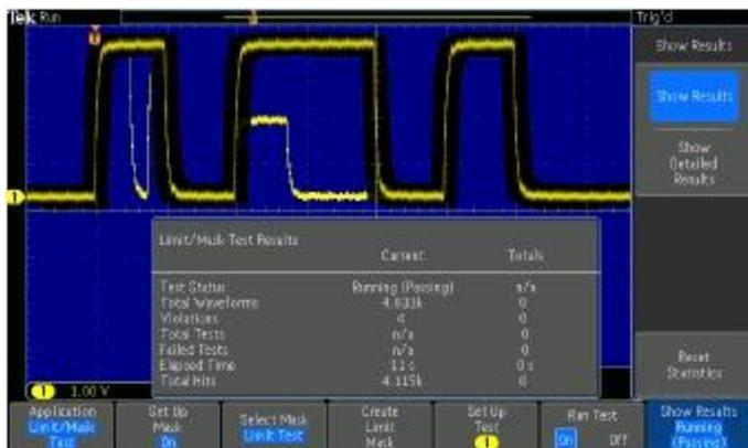
极限测试，显示从黄金波形中创建的模板，并与实时信号进行比较。结果显示与测试有关的统计信息。
