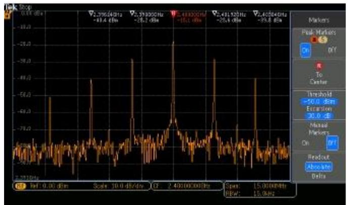
自动峰值标记让关键信息的标识一目了然。如此处所示，满足门限和偏移条件的五个最高幅度峰值被自动标记，并提供峰值的频率和幅度。
