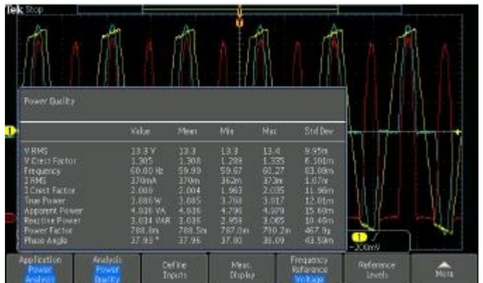
功率质量测量表。自动功率测量功能可以快速准确地分析常用电源参数。
