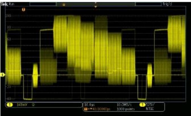
查看 NTSC 视频信号，注意 MDO3000 提供的亮度等级视图，其能够表示时间、幅度和幅度分布随时间变化。
