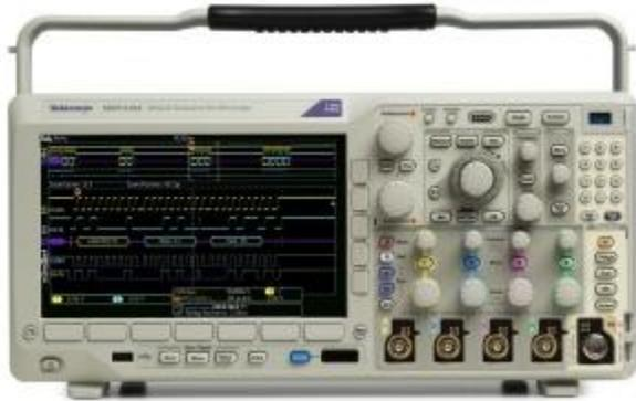
当今集成设计需要集成度与之相当的示波器，如 MDO3000 混合域示波器 (MDO) 系列。这是一种 7 合 1 示波器之集大成者，集成了一台示波器、一台频谱分析仪、一台任意函数发生器、一台逻辑分析仪、一台协议分析仪、一台数字电压表频率计。
