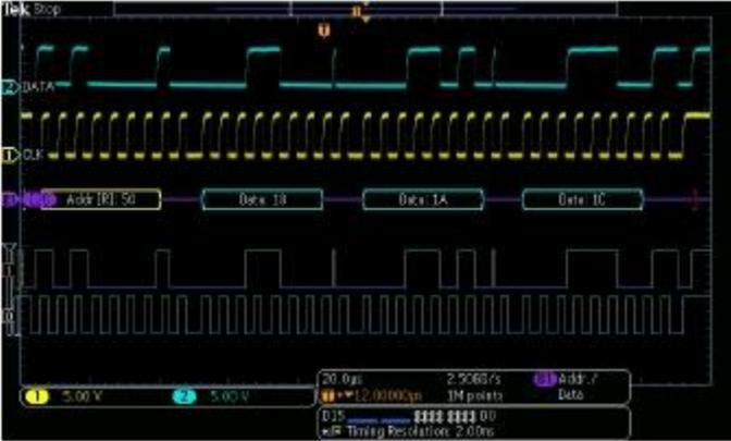
触发 I2C 总线上的特定地址和数据包。黄色波形是时钟，蓝色波形是数据。总线波形提供了解码后的包内容，包括开始、地址、读/写、数据和停止。
