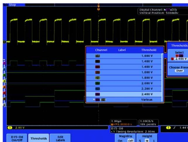
通过带色码的数字波形显示,可以简单地把多条数字通道一起放在屏幕上,创建一个组,然后作为组移动数字通道。可以为每条通道单独设置门限值,支持最多16个不同的逻辑家族。
