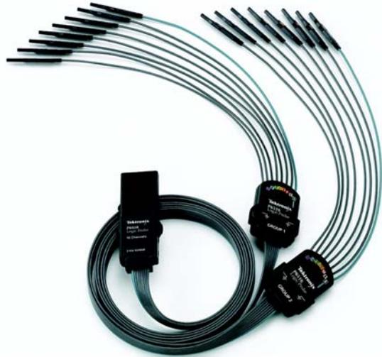
P6616 MSO探头提供了两个8通道适配夹,简化了与设备的连接。
