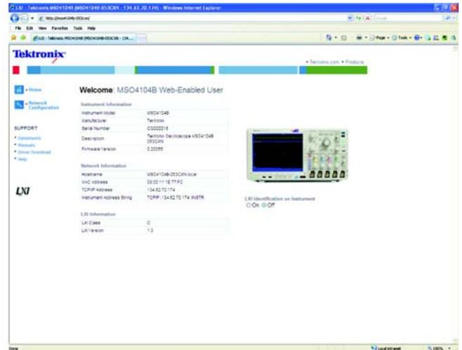
LXI 网络界面可以访问网络设置，实现远程仪器控制，可以从任何标准网络浏览器接入界面。
