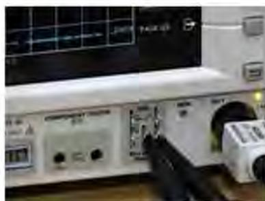
图1 在HMO系列示波器上总线信号源输出管脚
