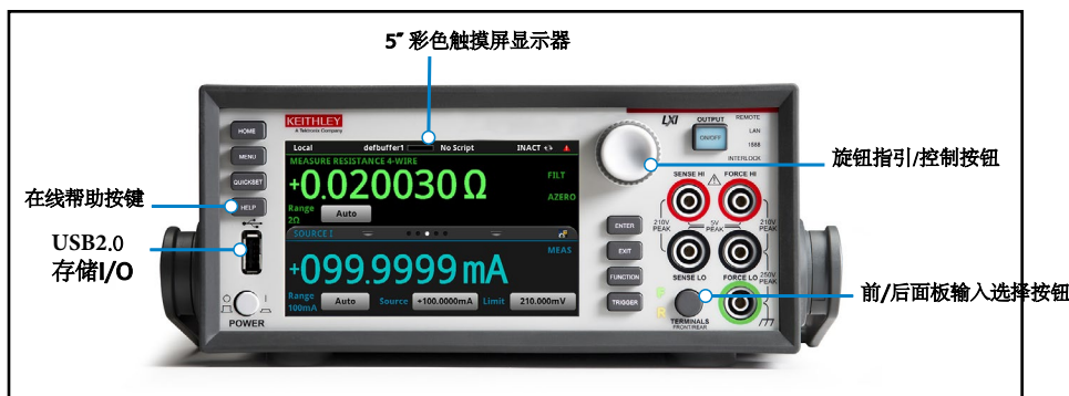
2460-OI仪器前面板，包括高分辨率电容触摸屏
