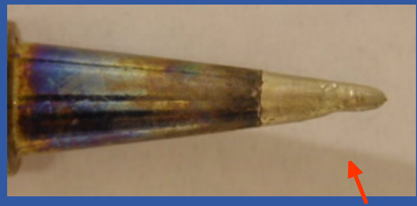
焊接 10000 此以后的烙铁头 (无铅焊料)
