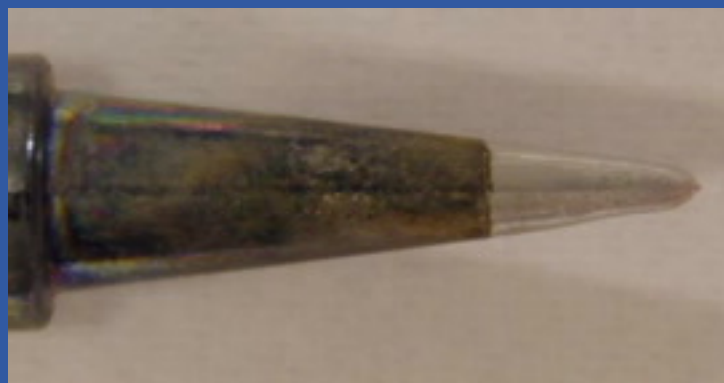
焊接 20000 此以后的烙铁头 (普通焊料)
