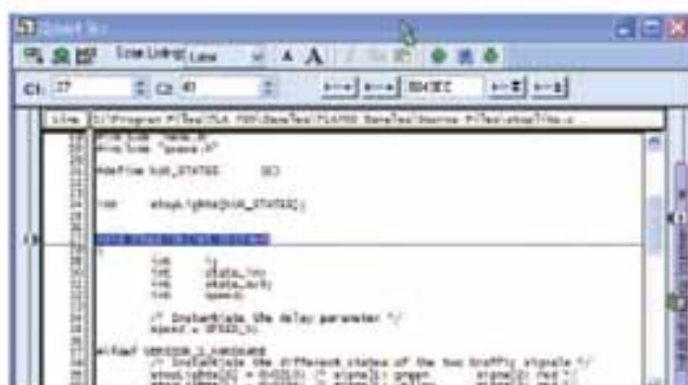
图 20. 源代码显示画面。这个画面中第 27 行与图 19 指令追踪显示画面中第 120 个样点相关。
