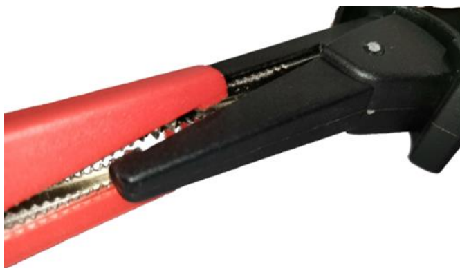
图 6-3-2 鳄鱼夹啮合前撑开状态
