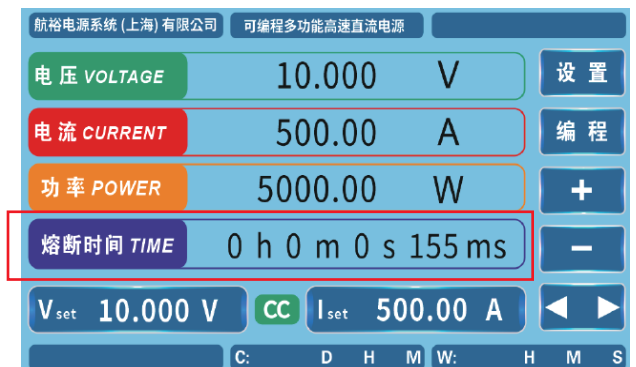
熔断器测试, 熔断时间显示可视化界面
