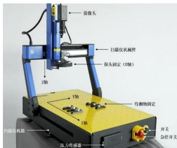
搭载高精度四向自动定位装置，扫描范围达400×300×200mm，重复定位精度高达±0.02mm，确保逐点扫描的准确性与可靠性。
