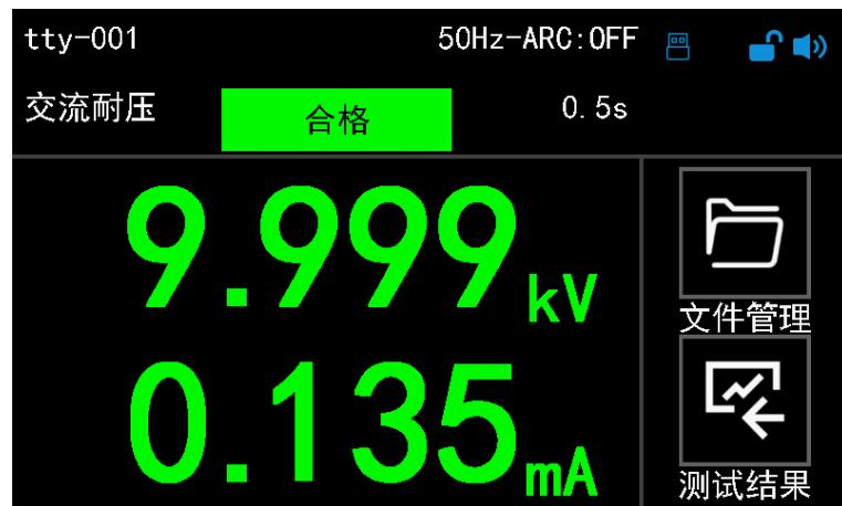
最高支持范围：电压：0.05KV-10KV； 电流：0.001mA-20.00mA
