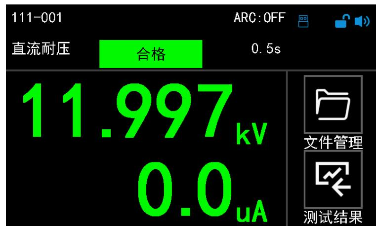
最高支持范围：电压：0.05KV-12KV； 电流：0.1uA-10.00mA
