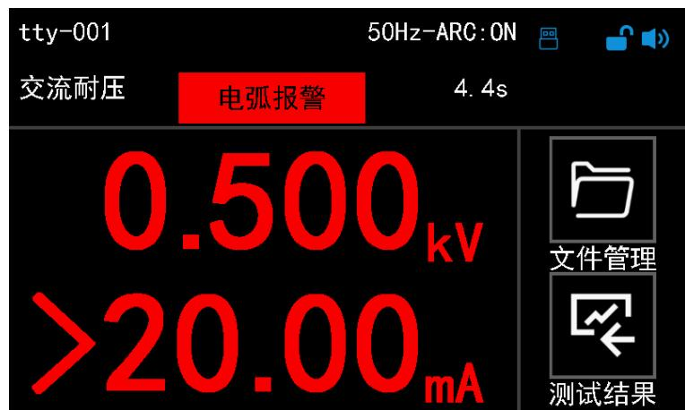
检测电气间距，导体绝缘体破损和接触不良情况下导致的高压放电
