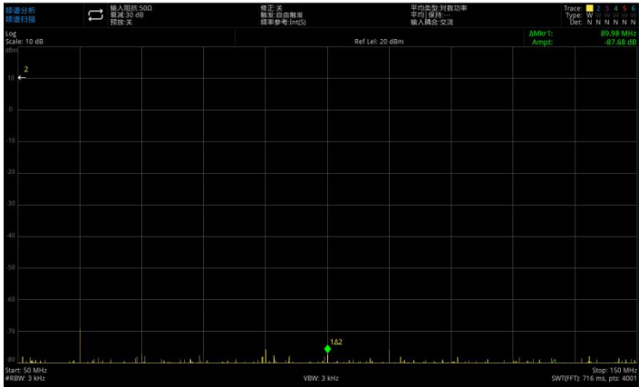
图 3-3：参考信号在屏幕外的 Delta 标记
