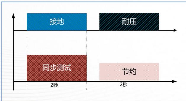
HEX304PV内置双功放技术同步输出高压与大电流，实现接地导通电阻与交/直流耐压同步测试，如上图所示可以有效地节约测试时间，解决速度瓶颈。
