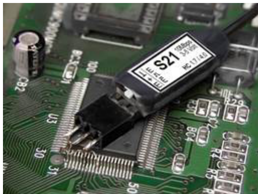
用传感器测量信号线上的瞬态磁场以及关键信号线的抗干扰能力
