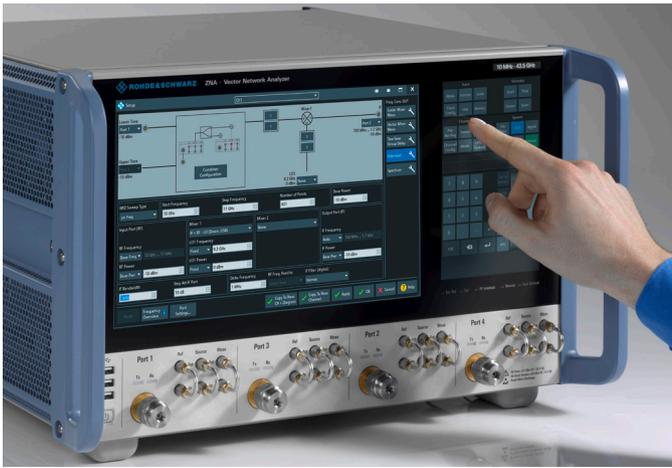
通过触摸面板控制R&S®ZNA。一体化对话框清楚显示所有关键参数,并可以跟踪整体测量配置,便于用户使用分析仪。
