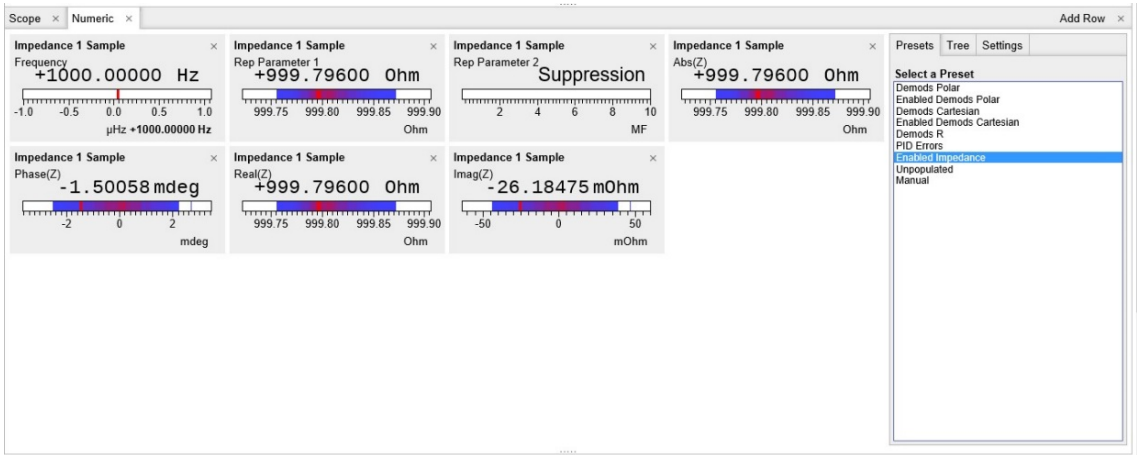
图 3.18. Numerical（数值）选项卡显示测量的阻抗和电路表示参数
