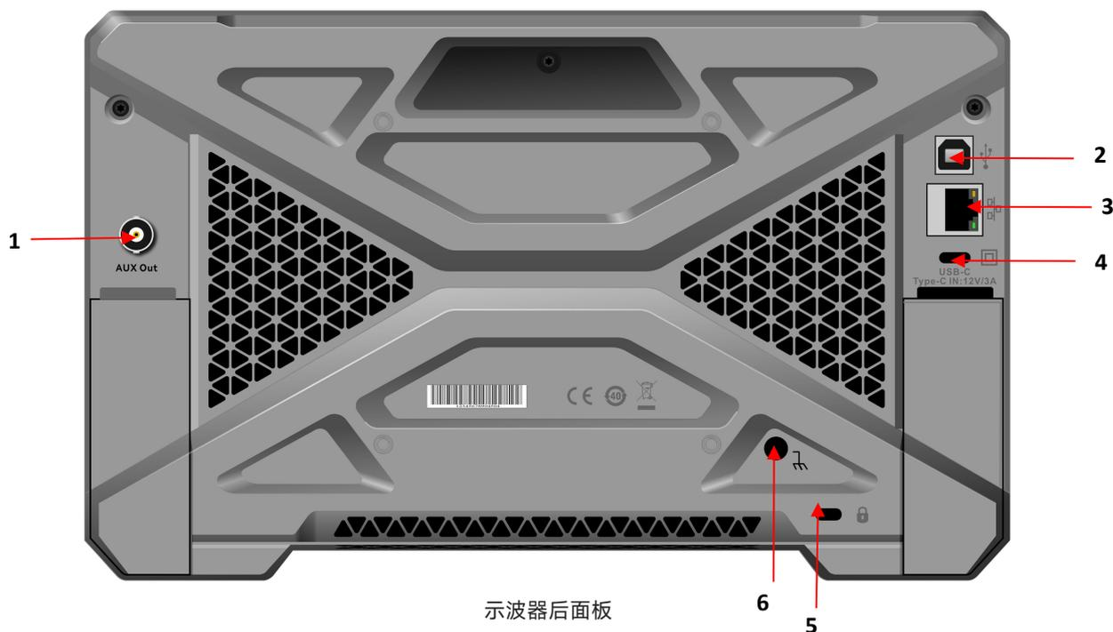
1. AUX Out: 输出端，同时支持触发、通过测试、DVM 等信号输出。
