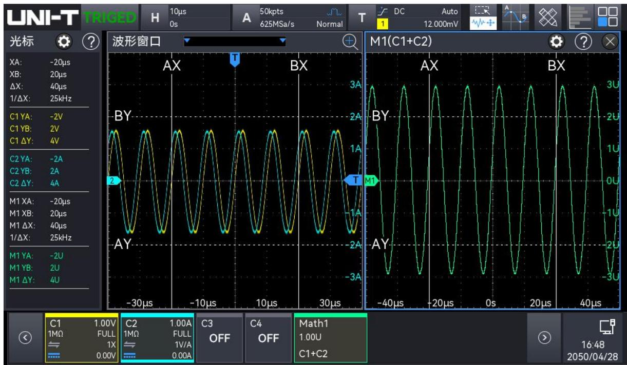
显示区域左上角光标测量信息显示框：“X”表示通道时间测量结果，“Y”表示电压类测量结果。
