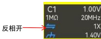
关闭波形反相时，波形正常显示；打开波形反相时，波形电压值被反相，如下图所示。打开波形反相还将会改变数学运算、波形测量等操作的结果。
