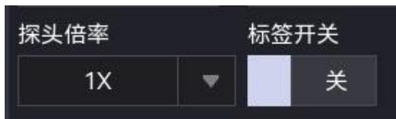
探头倍率可设置值有：0.001X、0.01X、0.1X、1X、10X、100X、1000X、自定义；当通道单位为：A 时，显示为电流探头，可设置：5mV/A、10mV/A、50mV/A、100mV/A、200mV/A、500mV/A、1V/A、自定义。自定义时，支持数字键盘设置倍率值。
