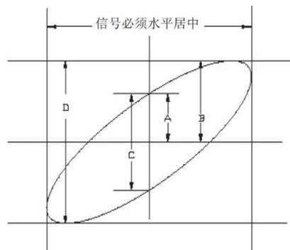
根据  $\sin\theta = A/B$  或  $C/D$ ，其中  $\theta$  为通道间的相差角，A、B、C、D 的定义见上图，因此可得出相差角即  $\theta = \pm \arcsin(A/B)$  或者  $\theta = \pm \arcsin(C/D)$ ，如果椭圆的主轴在 I、III 象限内，那么所求得的相位差角应在 I、IV 象限内，即在  $(0 - \pi/2)$  或  $(3\pi/2 - 2\pi)$  内。如果椭圆的主轴在 II、IV 象限内，那么所求得的  $(\pi/2 - \pi)$  或  $(\pi - 3\pi/2)$  内。
