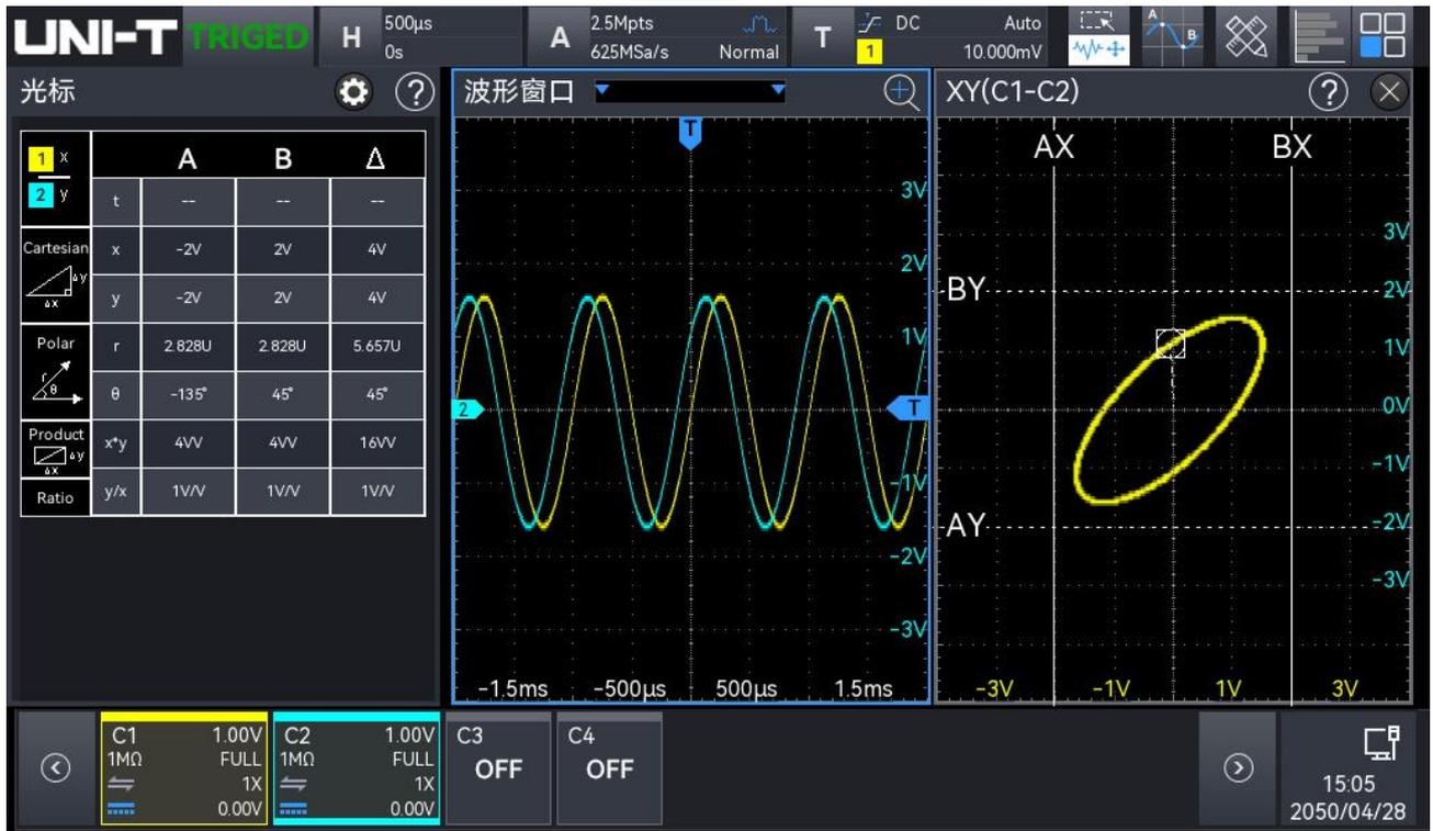
打开 XY 时，Cursor 支持时间和电压光标测量。时间测量时，光标显示在波形窗口，且只能在波形窗口移动光标；电压测量时，光标显示在 XY 窗口。时间、电压光标具体使用请参考[光标测量](#)。
