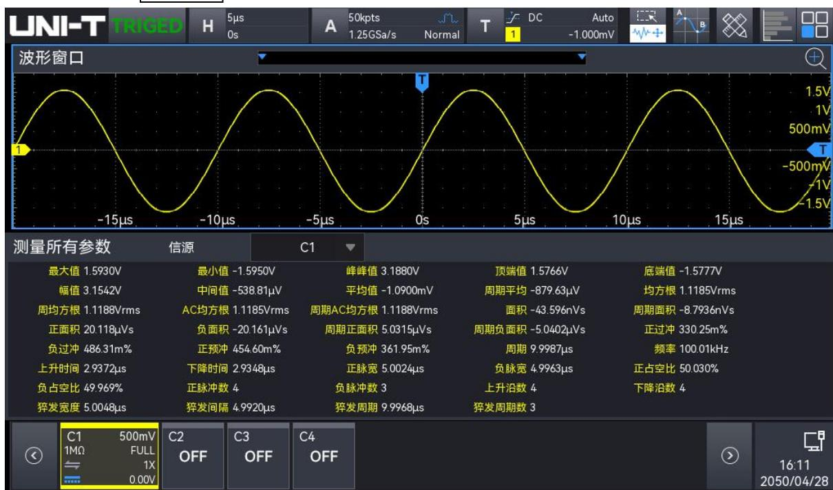
参数快照弹框可设置对不同源进行测量，点击“源”下拉框，选择需要测量的源，可选择 C1 - C4、M1 - M4。测量结果颜色与所有源的主题颜色保持一致。
