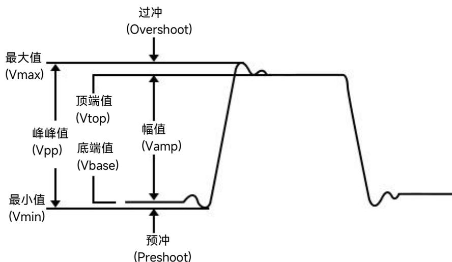
最大值：波形最高点至 GND（地）的电压值。
