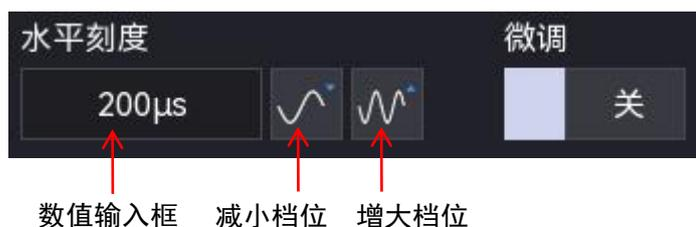
UPO1000HD 系列示波器支持水平微调，您可以通过按下前面板右侧的 水平 Scale 旋钮切换“粗调”和“微调”。
