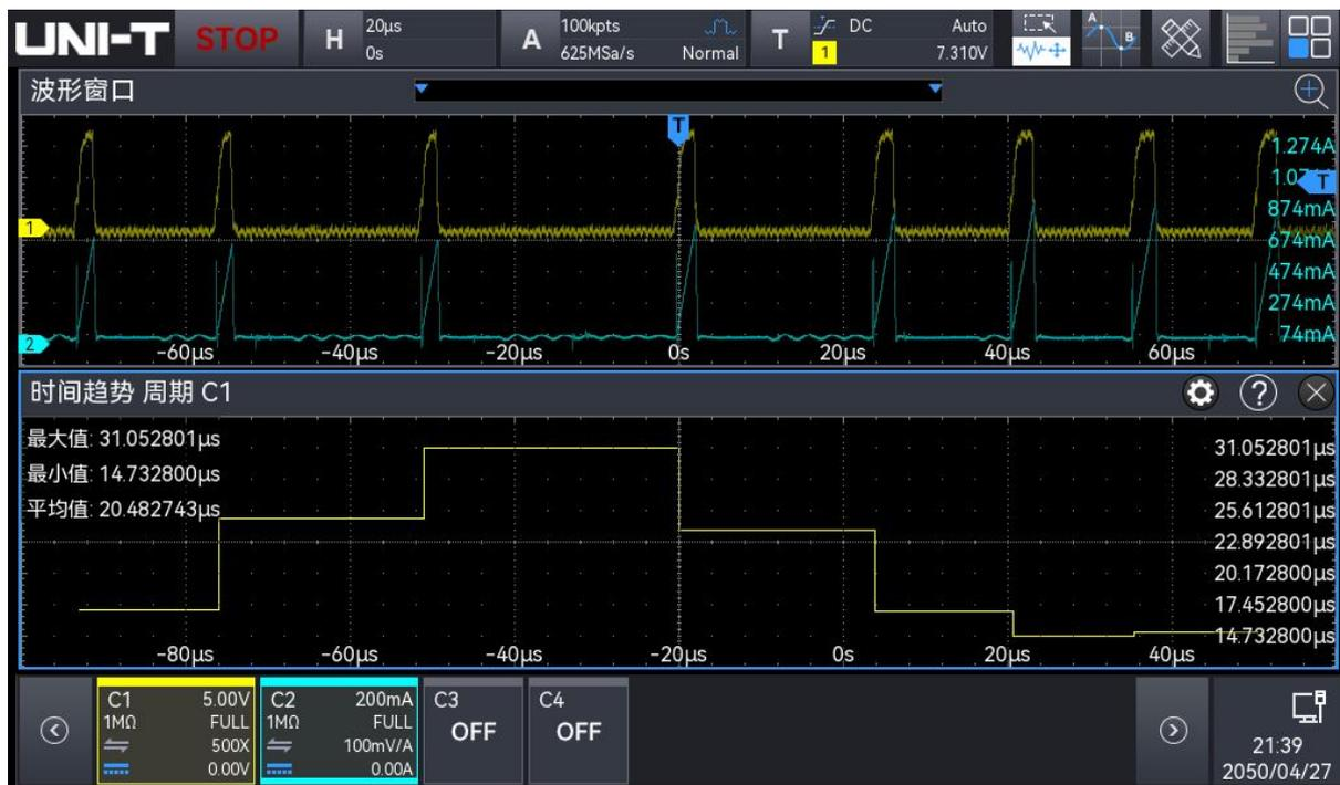
时间趋势图使用测量趋势数学波形可视化来绘制调制波形的每个周期的测量变化。
