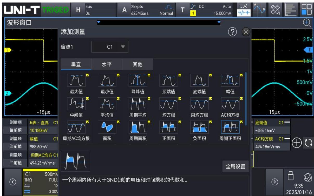
参数测量显示在伏格信息框上方，显示测量项、当前值两项。参数测量中，默认将计数器、电压表显示在最左侧，自定义参数显示在其后。参数测量最多支持设置 21 个参数。
