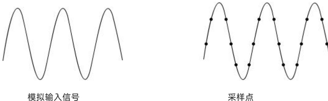
采样率指示波器两个采样点之间的时间间隔，UPO1000HD 系列高分辨率示波器的最高采样率为 1.25 GSa/s。
