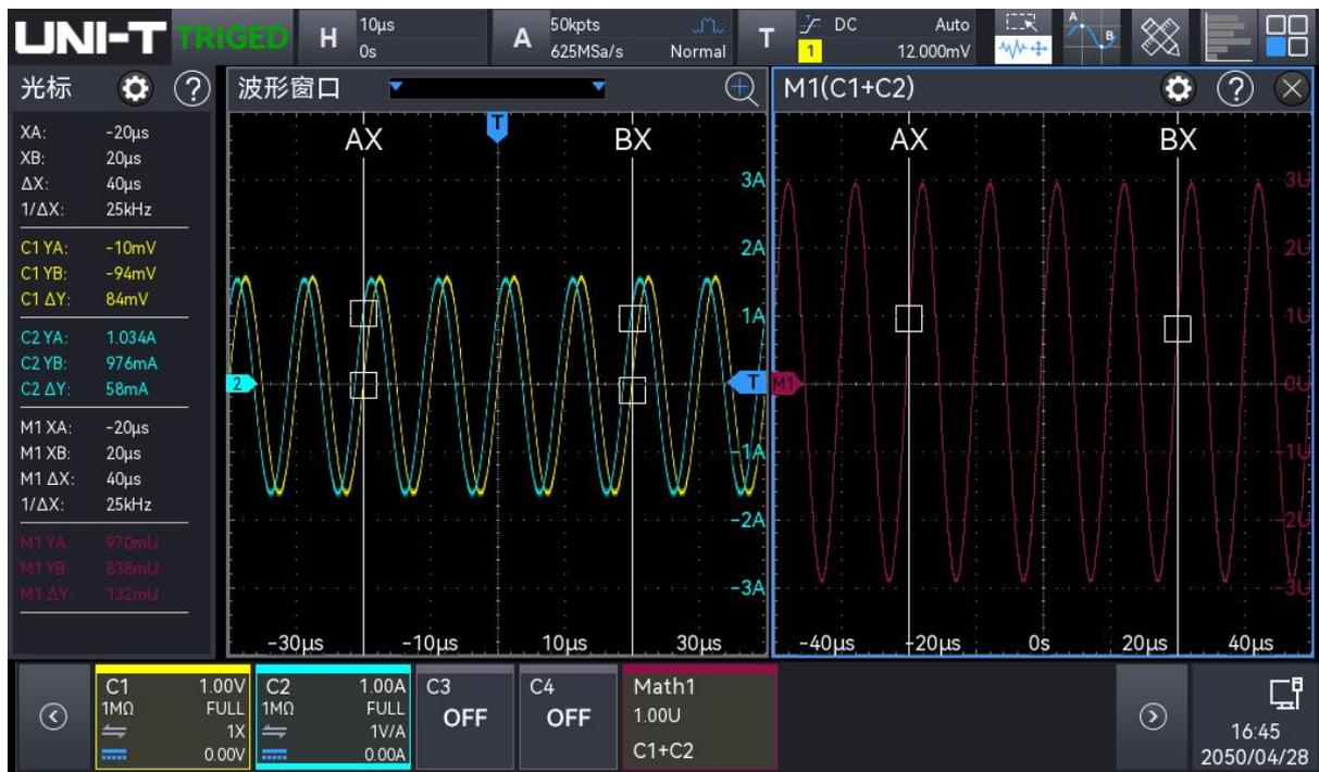
光标结果信息显示框：“X”表示通道时间测量结果，“Y”表示打开通道与光标交点的电压测量结果。
