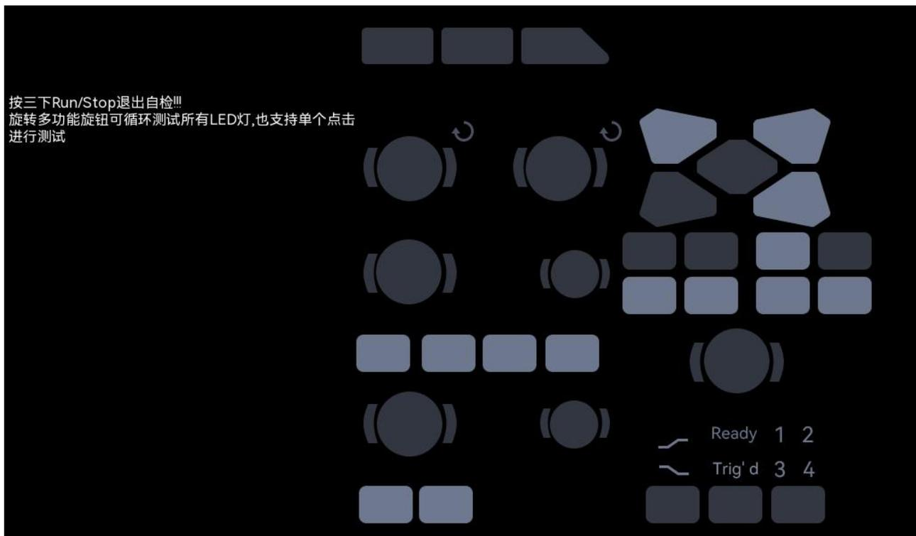
旋钮测试：进入 LED 测试，旋转 Multipurpose A后，前面板上第一个 LED 被点亮，同时屏幕中该键对应位置变亮。继续旋转 Multipurpose A 可切换至前面板上下一 LED 灯。按照此法连续旋转 Multipurpose A 直至所有按键灯均被测试，观察前面板所有 LED 灯是否能被实时点亮。
