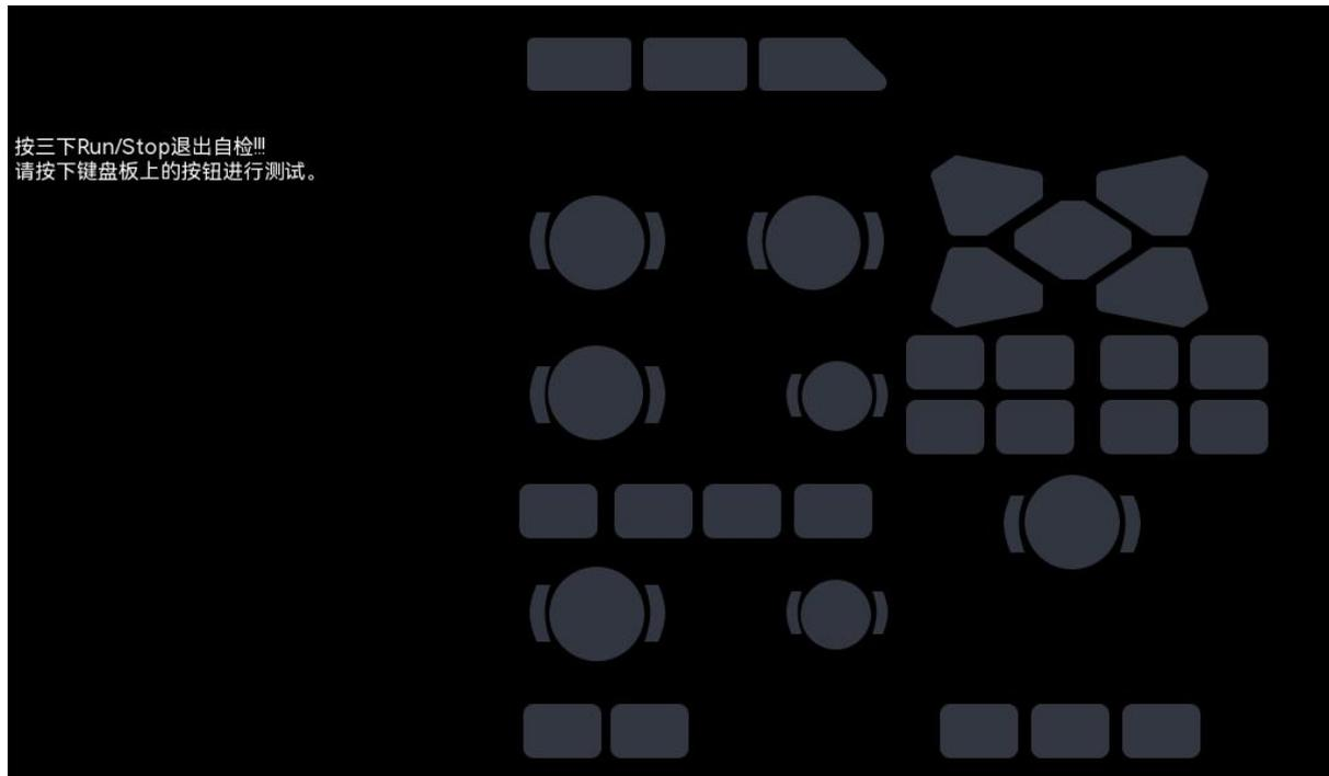
旋钮测试：按照从上向下，从左向右的顺序依次向左或向右旋转各旋钮并按下，观察显示界面上对应旋钮是否变亮。
