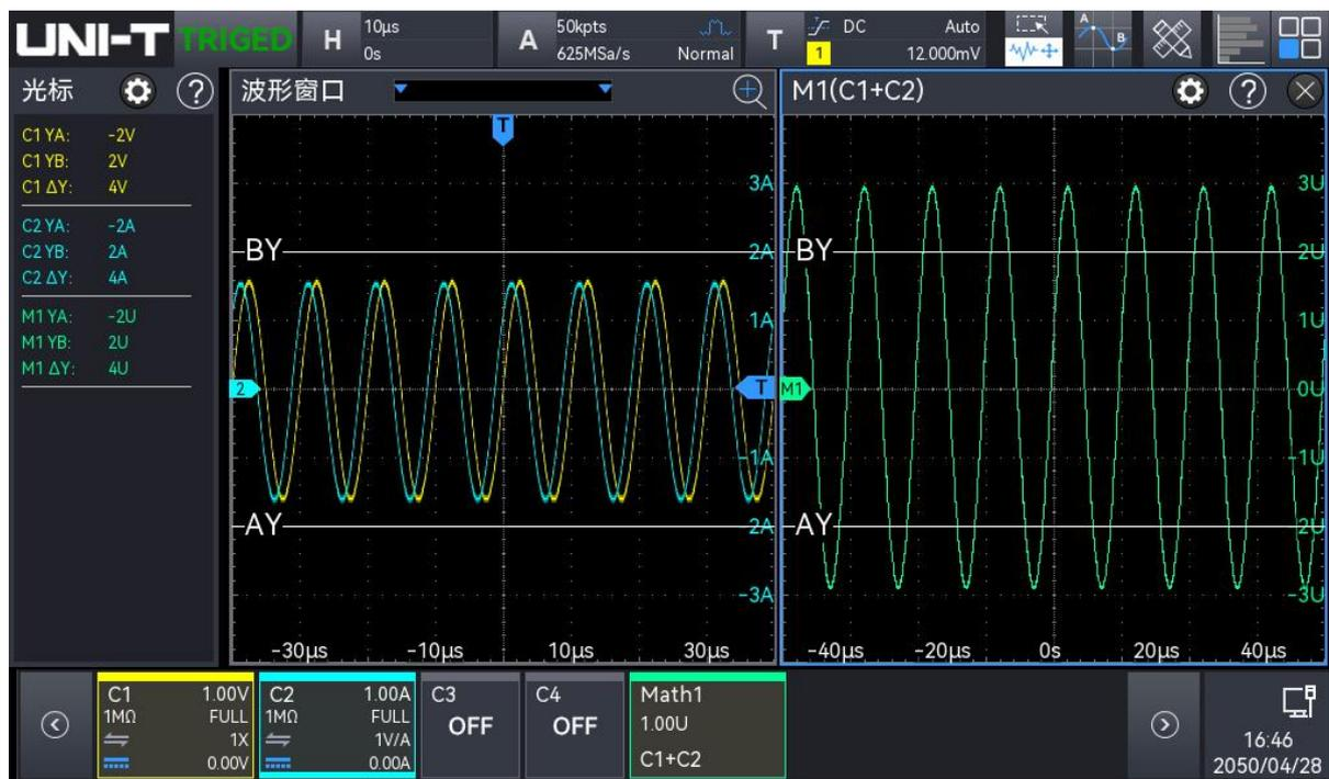
显示区域左上角光标测量信息显示框：“Y”表示电压类测量结果。
