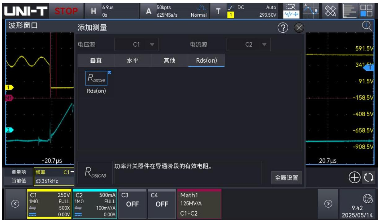
■ 开关损耗参数：开关周期数、开通功率损耗、导通功率损耗、关断功率损耗、功率损耗总计、开通能量损耗、导通能量损耗、关断能量损耗、能量损耗总计
