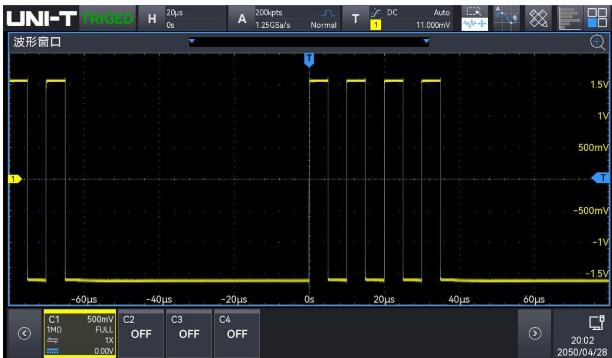
按下前面板的 触发 Menu 软键，或触摸屏幕顶部 T 触发信息框，打开“触发”菜单。点击“触发释抑”输入框，通过弹出的数字键盘设置释抑时间（直至波形稳定触发，默认为 80 ns），数字键盘具体使用方法请参考 5.8 章节 [参数设置方法](#)；也可以旋转前面板的 Multipurpose A 调节释抑时间。释抑时间的可调范围为 0 s 至 10 s。
