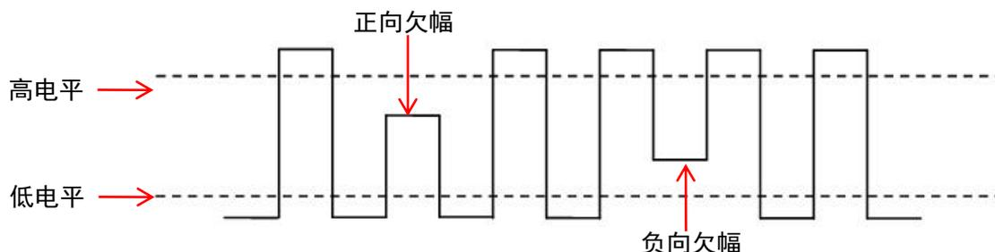
欠幅触发菜单列表可设置：信源、触发方式、极性（正极性、负极性）、欠幅条件（无关、<、>、 $\leq$ ）、时间下限/时间上限、高电平/低电平等。
