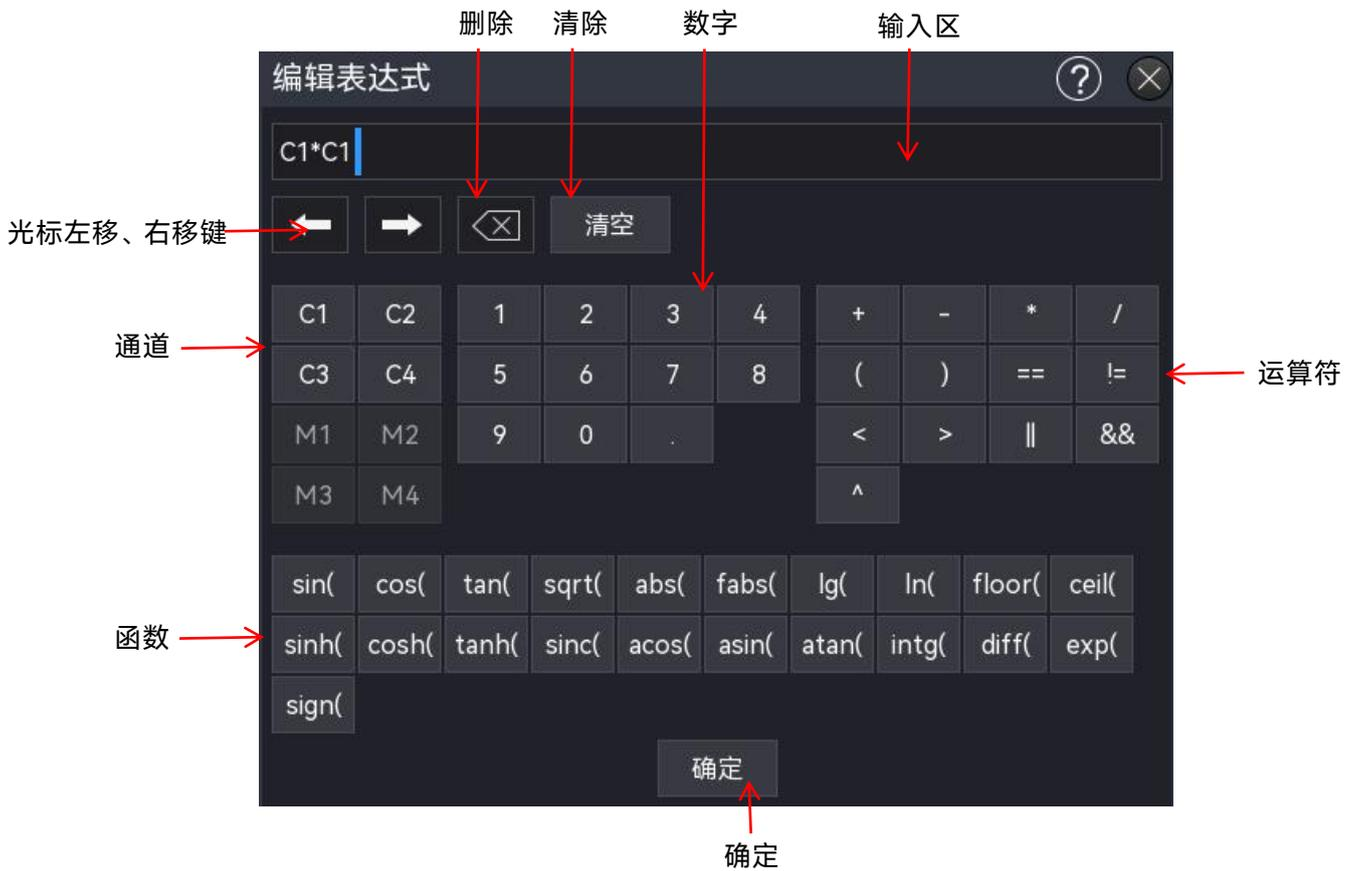
编辑表达式弹框中，触摸选择内容并编辑正确的表达式。
