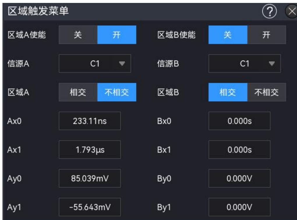
区域触发，提供两个矩形区域：区域 A、区域 B，两个区域均支持设置区域触发条件：相交、不相交；两个区域均支持设置对应的作用信源 C1 - C4。
