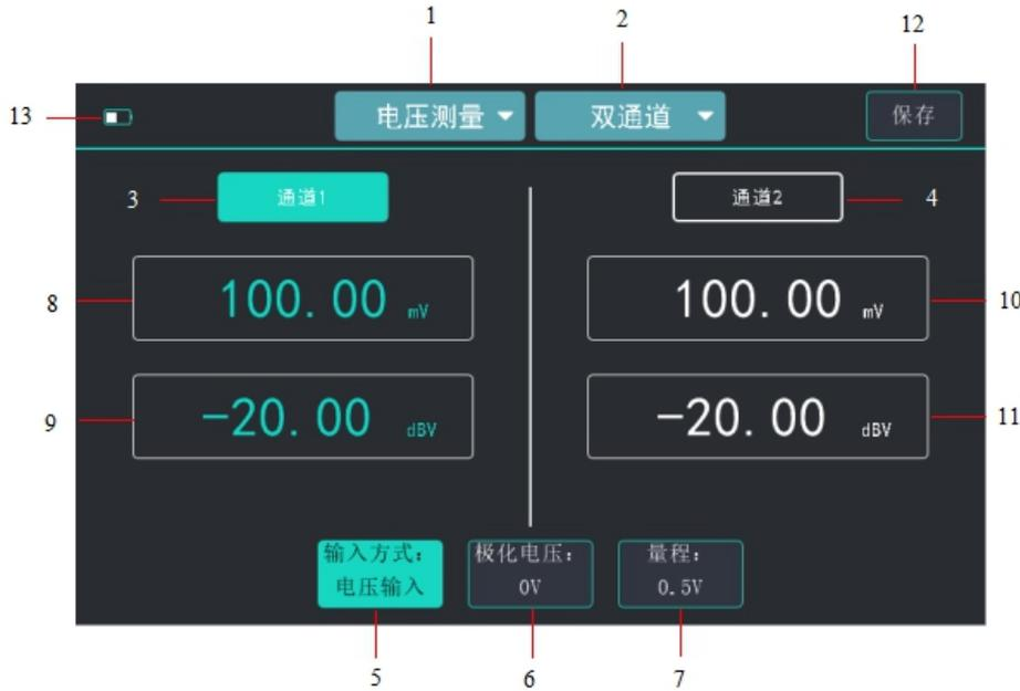
图 4.2 双通道电压测量界面
