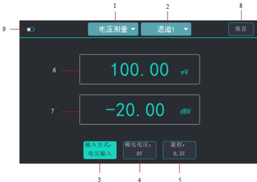
图 4.1 单通道电压测量界面
