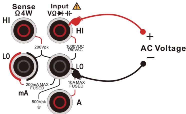
图 2 - 27信号频率测量连接示意图
