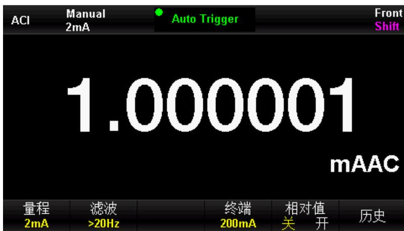
图 2 - 17交流电流测量界面
