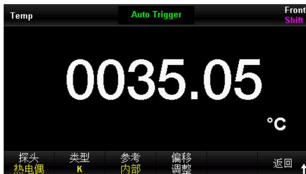
图 4-12 K型热电偶温度测量界面
