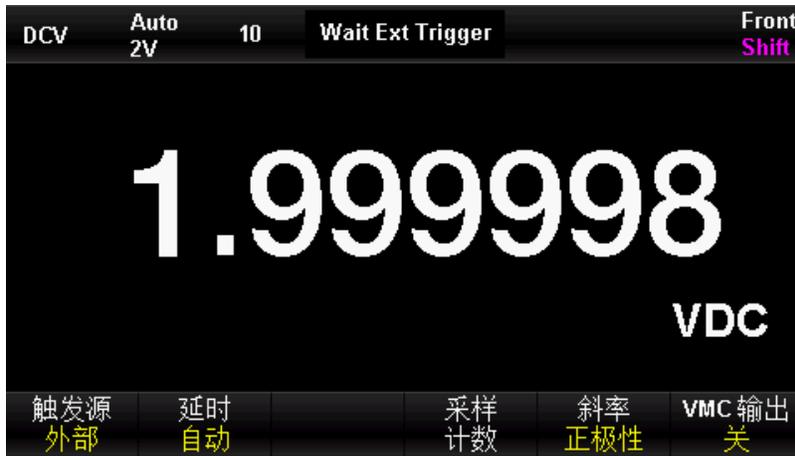
图 2 - 48外部触发设置界面
