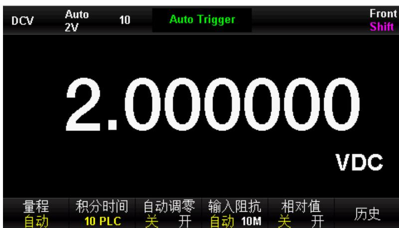
图 2 - 10 直流电压测量界面
