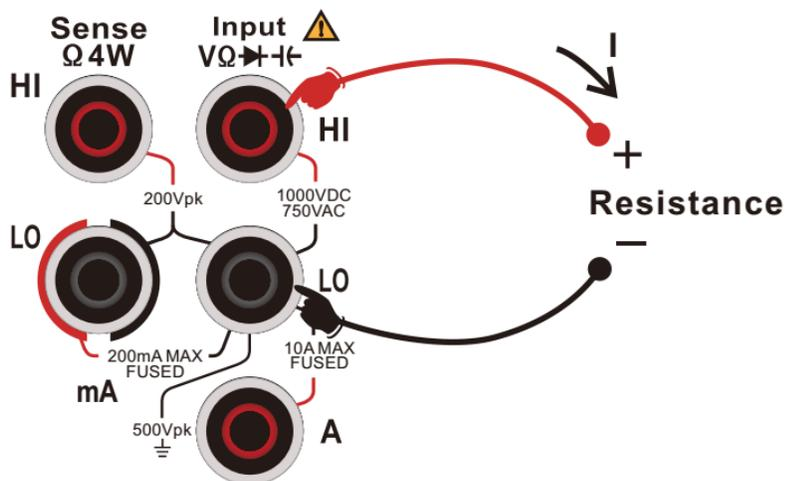
图 2 - 21 二线电阻测量连接示意图
