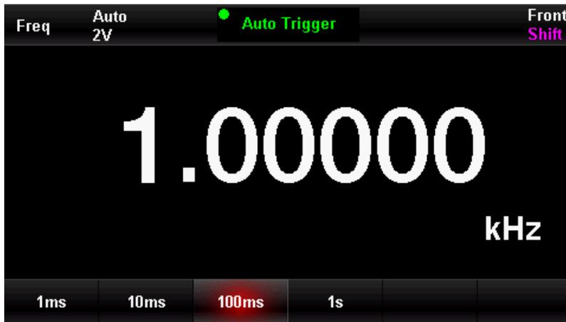
图 2-9 设置测量间隙时间
