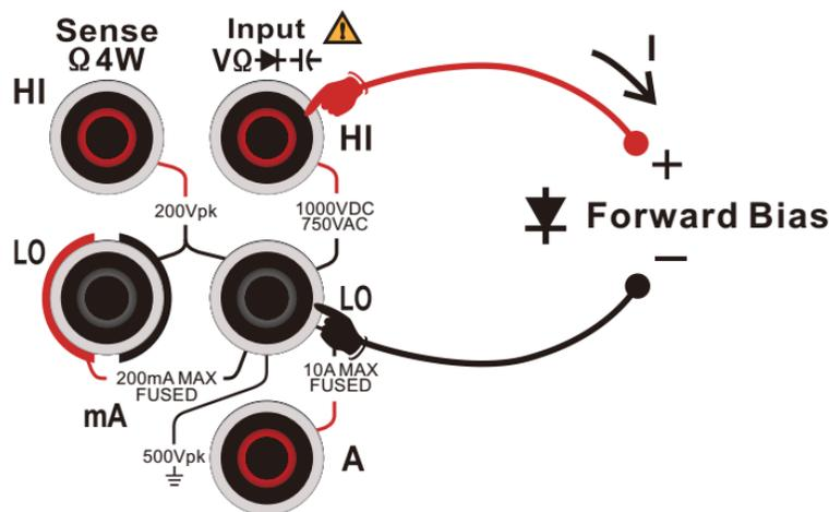
图 2 - 33 二极管测量连接示意图
