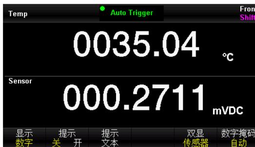
图 4-14 温度测量双显示界面 2
