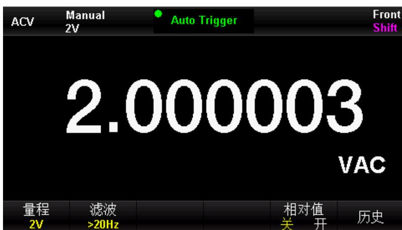
图 2 - 14 交流电压测量界面
