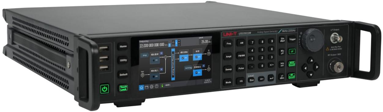
USG5000M 系列射频模拟信号发生器能够提供高质量信号，准确信号电平和超宽输出功率范围，满足如无线通信，航空航天，汽车电子，生产制造，半导体等复杂测试需求。
