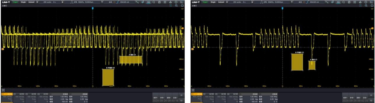
使用区域触发快速隔离不关心的信号，快速找到关键信息，不必花费过多时间学习高级的触发逻辑
