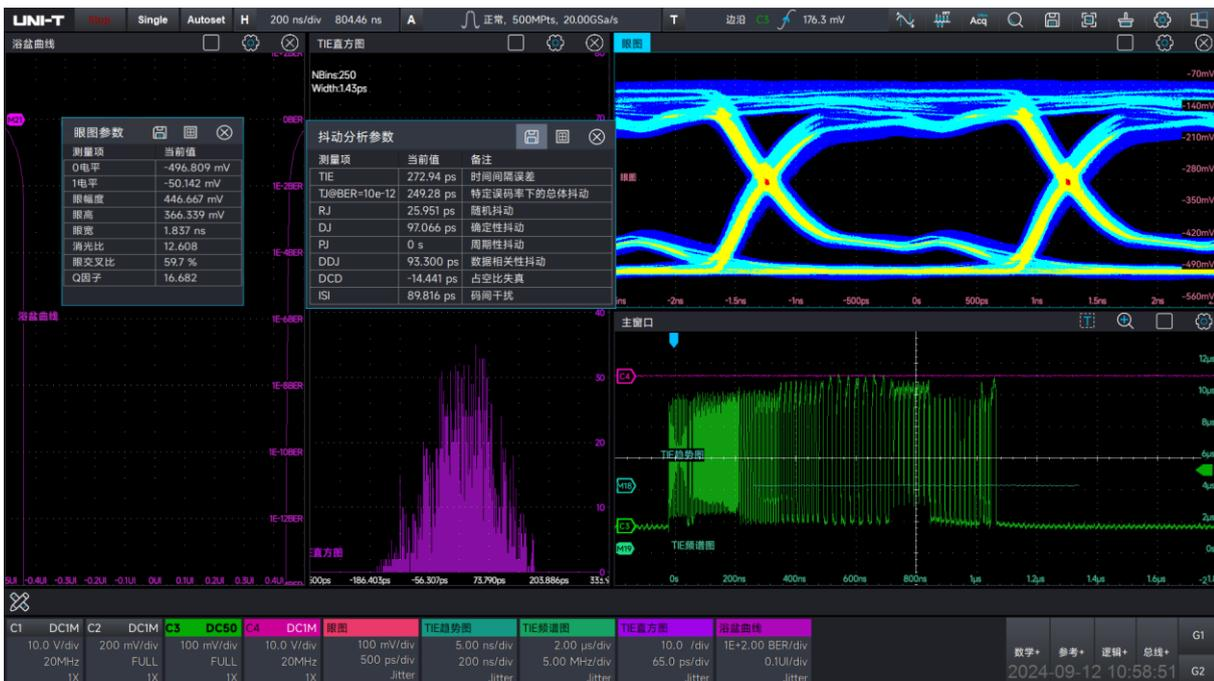
MSO8000HD-JITTER 抖动分析和眼图选件具备完备的抖动测量算法以及丰富的抖动分析视图
