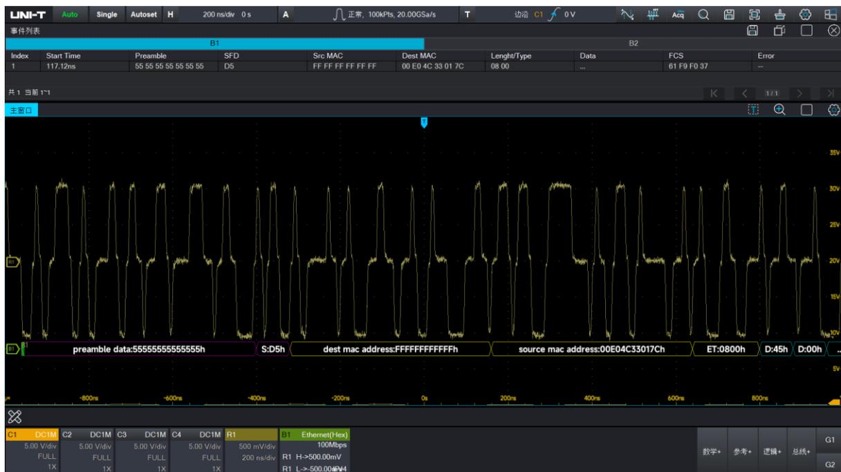
分析 100M 以太网总线。总线波形提供时间相关的解码后的包内容，包括前导数据、起始帧界定符、目的媒体控制访问地址、源地址等，事件列表展示采集的所有包内容
