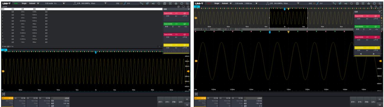
对设定的条件进行搜索，如脉宽搜索，可以找到所有符合条件的脉宽，带有颜色的三角标定了位置，且展示出搜索出的脉宽长度，如果您对差异太大的脉宽感兴趣，您可以暂停下来，导航到脉宽位置进一步分析。
