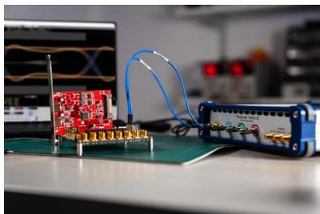
SXRT0 系列模型以与实时示波器相同的方式存储数据，即使用连续捕获和循环内存缓冲区，实时示波器与 SXRT0 之间的
