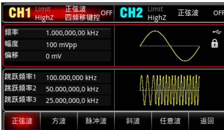
按 **频率** 软键，按数字键盘，使用数字键盘输入 500Hz。
