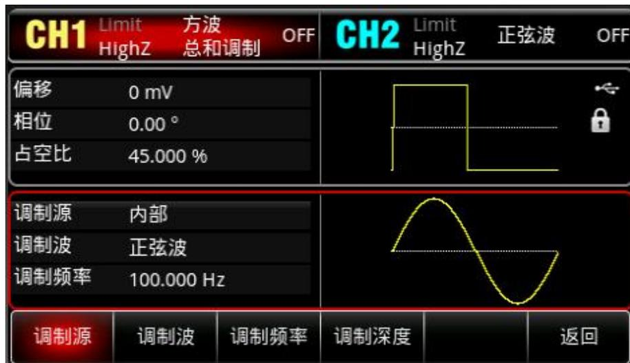
按 **调制频率** 软键，按数字键盘，使用数字键盘输入 1kHz。
