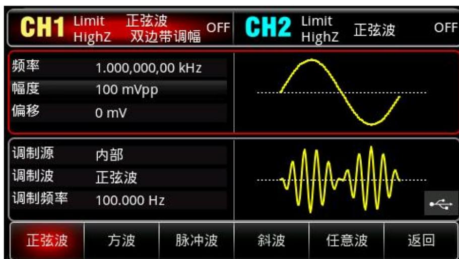
按 **频率** 软键，按数字键盘，使用数字键盘输入 2kHz。
