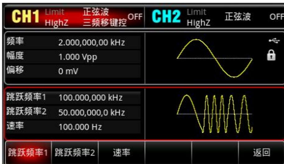
按 **速率** 软键，按数字键盘，使用数字键盘输入 100Hz。
