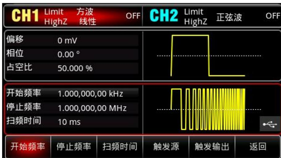
按开始频率软键，再使用数字键盘输入1，然后选择参数单位 kHz。开始频率默认为1kHz。
