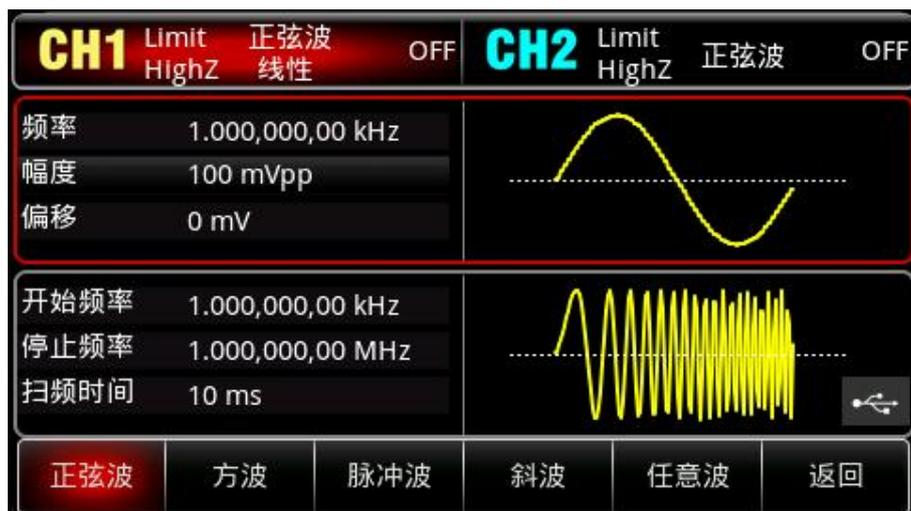
按 **幅度** 软键设置幅度，使用数字键盘输入 1，然后选择参数单位 **Vpp**；
