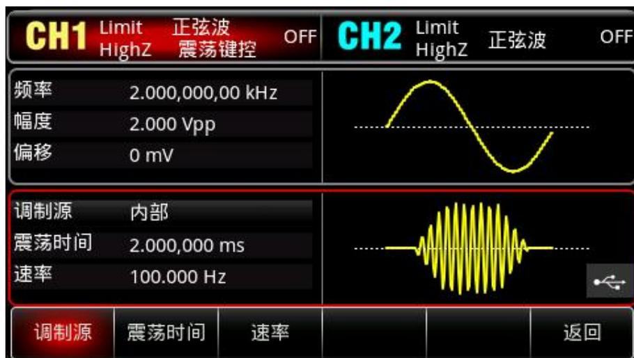
按 **速率** 软键，按数字键盘，使用数字键盘输入 100Hz（默认为 100Hz）。
