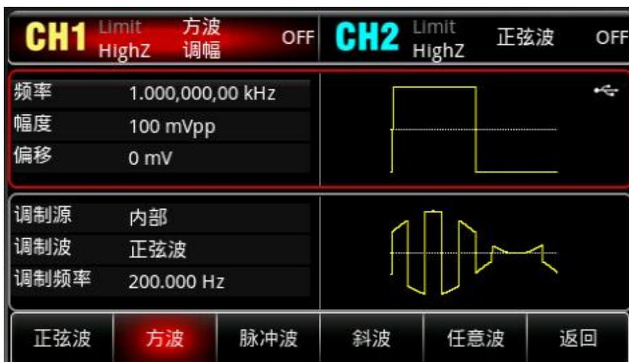
按 **频率** 软键设置频率，使用数字键盘输入 10，然后选择参数单位 **kHz**；
