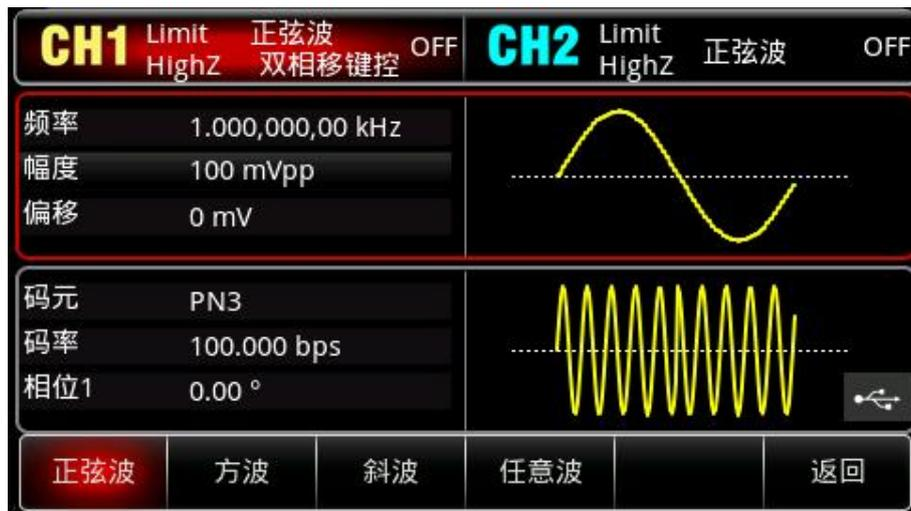
按 **频率** 软键，按数字键盘，使用数字键盘输入 2kHz。
