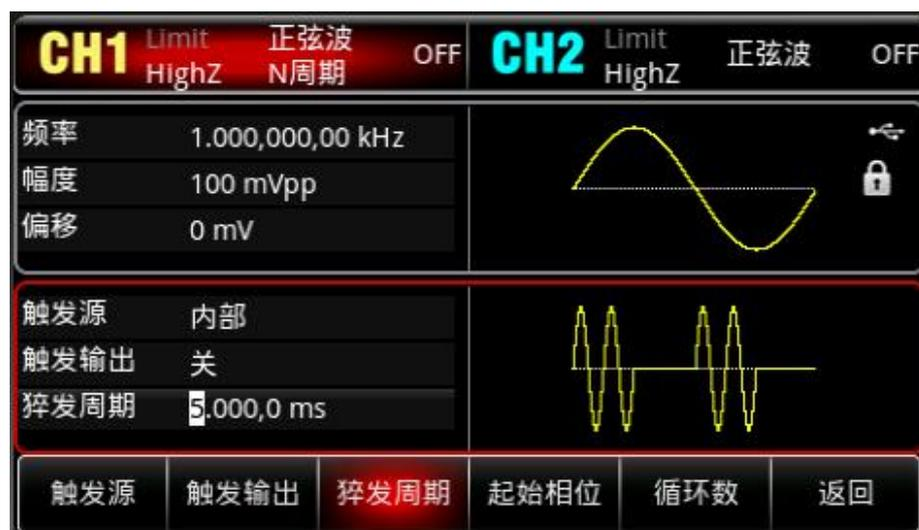
猝发周期（脉冲串周期）仅适用于N循环模式，定义为从一个脉冲串开始到下一个脉冲串开始的时间，当触发源选择为外部触发时，参数列表会隐藏猝发周期（脉冲串周期）选项。猝发周期（脉冲串周期）的可设置范围为  $1\mu\text{s} \sim 500\text{s}$ ，默认“猝发周期”时间为  $2.0001\text{ms}$ ，若要进行更改在选择脉冲串的类型为
