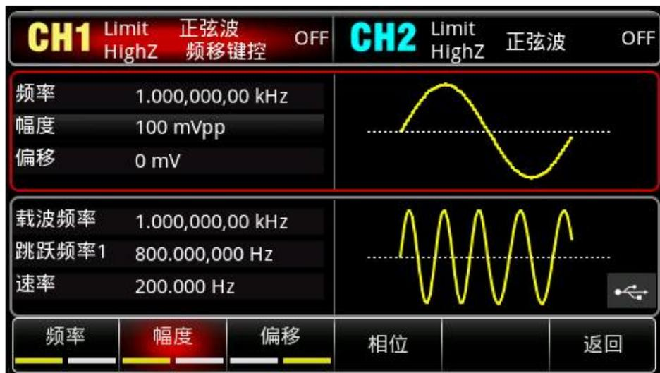
按 **频率** 软键设置频率，使用数字键盘输入 2，然后选择参数单位 **kHz**；
