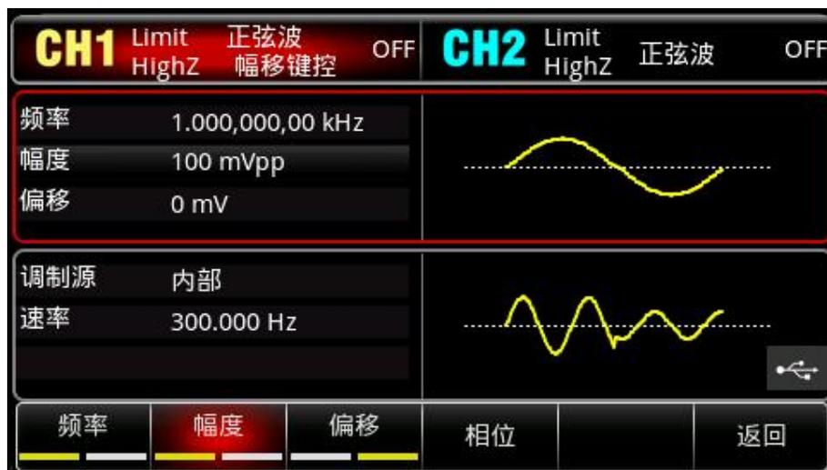
按 **频率** 软键设置频率，使用数字键盘输入 15，然后选择参数单位 **kHz**；
