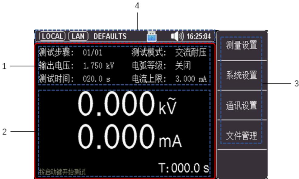
图 4-1 单通道测试显示界面
