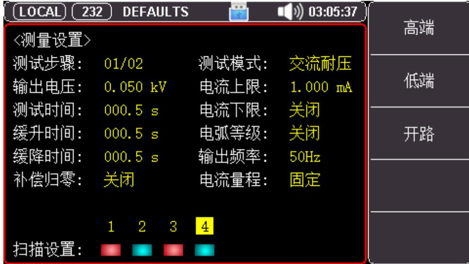
UT5320R-S4A/S8A 在测试模式为交流耐压、直流耐压、绝缘电阻时，可以配置多通道的扫描通道；
