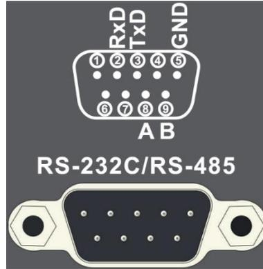
连接本仪器与 PC 时，使用 D-sub 9 针母头 — D-sub 9 针母头的交叉线。
