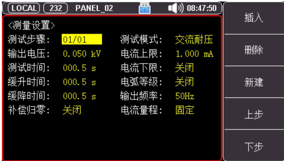
界面上显示，**测试步骤: 01/01**的含义为 **测试步骤: 当前设定项目序号 / 总测试项目数**。
