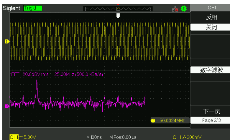
图 2-13 分屏显示 FFT 波形
