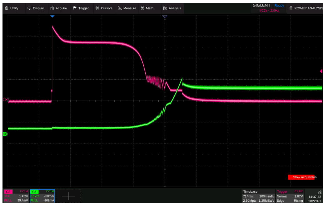
上电时 MOSFET 上的电压和电流波形
