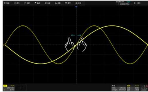
通过水平方向的两点缩放手势控制波形的水平档位
