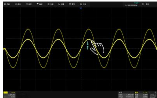
通过垂直方向的两点缩放手势控制波形的垂直档位。当多个通道打开时，控制的是波形离触摸区域最近的通道
