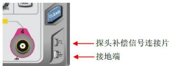
图 4-1 探头补偿信号连接片和接地端
