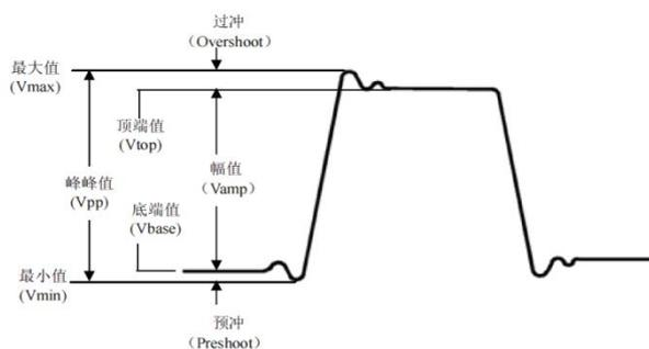
最大值 (Max)：波形最高点至 GND (地) 的电压值。
