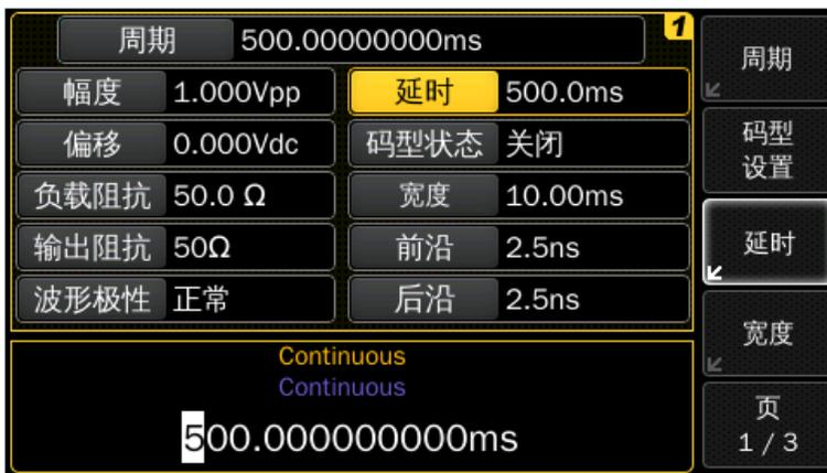
若延时参数已选择，再次按下延时按键，显示延时的下一级菜单，按对应的软键可切换延时的表示方式和单位。
