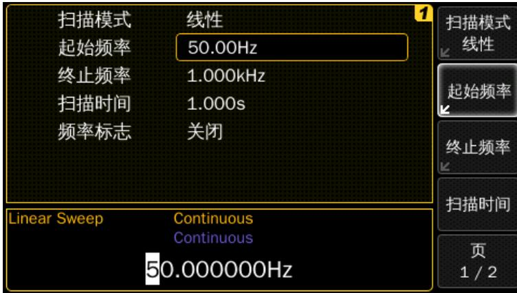
**设置终止频率：**按〔终止频率〕键，设置为 5 kHz。此时，仪器输出一个从 50 Hz 到 5 kHz 的正弦波扫描。
