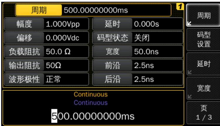
按【宽度】键，将脉冲波宽度设置为 10 ms，脉冲波宽度是从脉冲前沿 50 %幅度处与脉冲后沿 50 %幅度处之间的时间，
