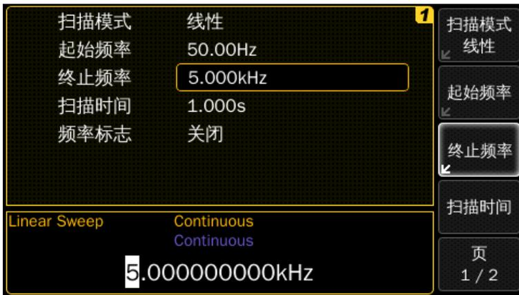
除用起始频率、终止频率外，还可使用中心频率和频率跨度来设置扫描的频率边界，这些参数作用与起始频率和终止频率作用相同。
