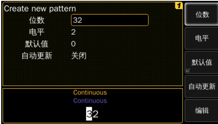
**配置新码型：**通过上图界面中显示的所有信息来配置新码型。完成后，按编辑软键可在码型编辑界面中打开新创建的码型。
