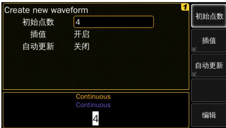
**选择插值：**按插值软键启用或禁用波形点之间线性插值(此功能仅从前面板可用)。在启用插值(默认)时，波形编辑器在点之间建立直线连接。在禁用插值时，波形编辑器保持点之间的恒定电平，并创建一个“步进式”波形。
