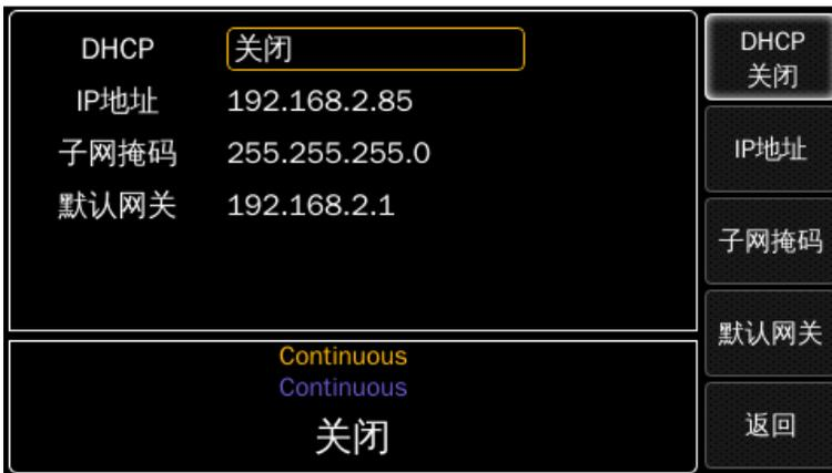
按 DHCP 软键，可以循环选择 DHCP 的开启或关闭，如果选择 DHCP 打开，那么 IP 地址、子网掩码和默认网关都不能进行设置。
