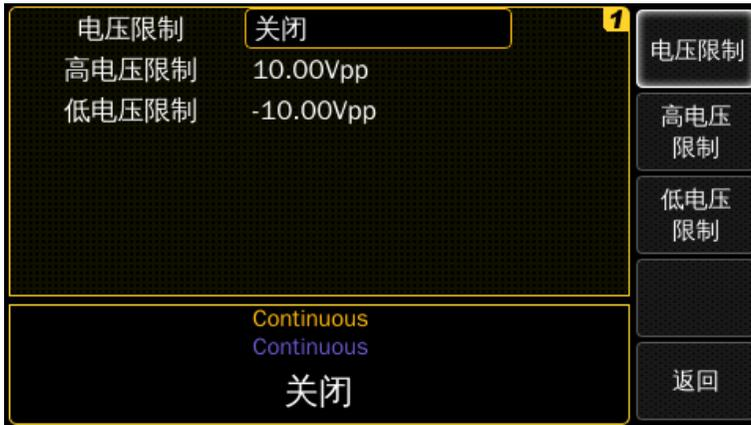
**前面板操作：**按【Utility】键，选择输出设置，重复按电压限制软键来开启/关闭限制。
