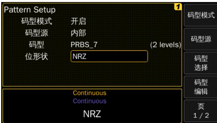
按【码型选择】键显示内部码型存储界面，显示内建 PRBS 码型或用户定义的码型，使用旋钮进行选择。
