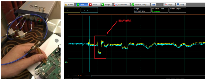
图 8 PICO 9311-20 采样示波器 TDR 测试接线及测试结果图
