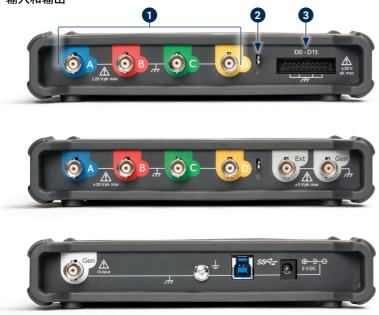
注:此处显示的是 PicoScope 5000D 系列 4 通道型号。其他型号可能具有不同的连接器布局。有关详细信息,请参考示波器的数据表。
