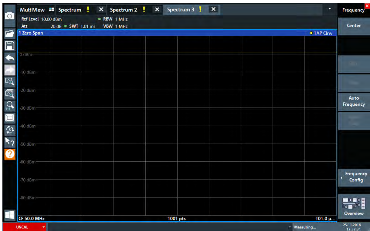
图 6-7: 校准信号的时域显示
