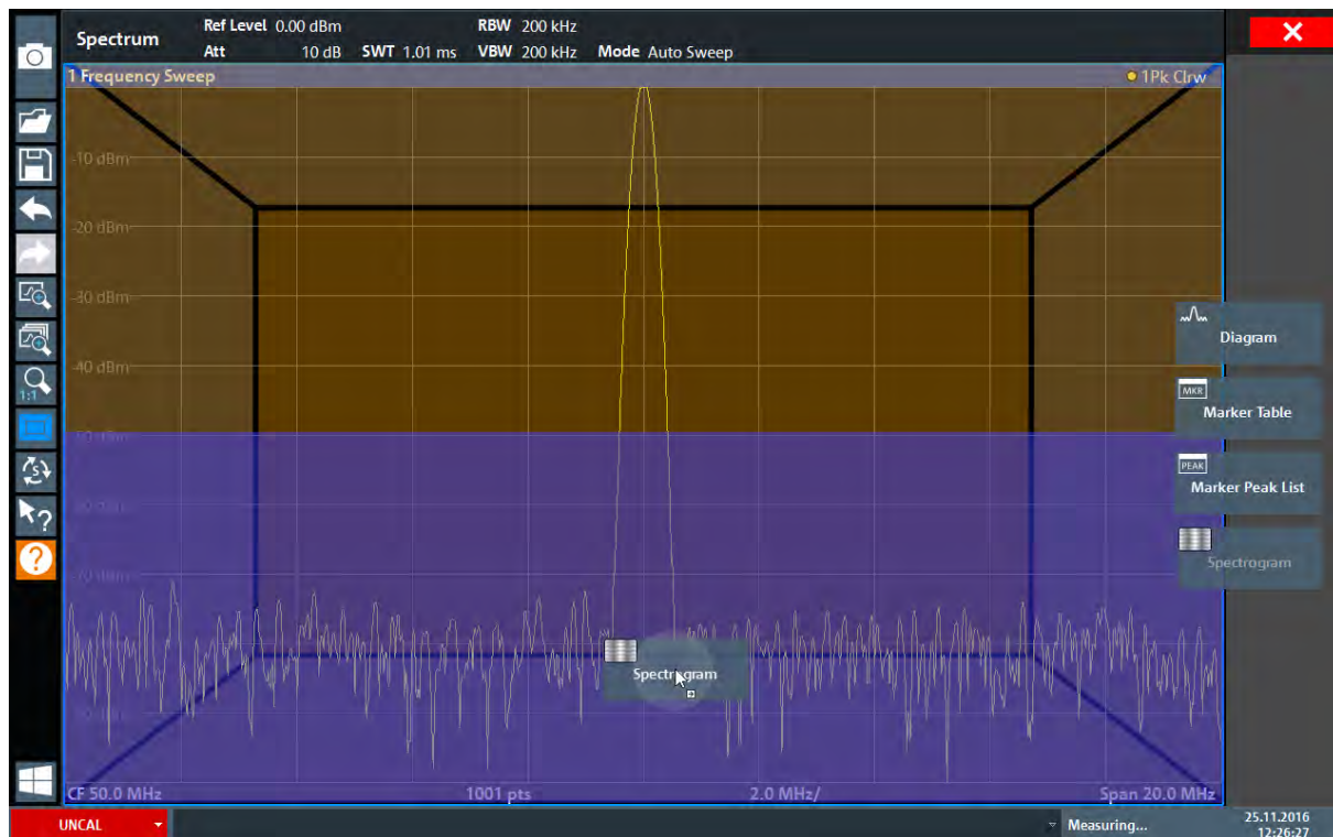
图 6-3: 将瀑布图添加到显示中
