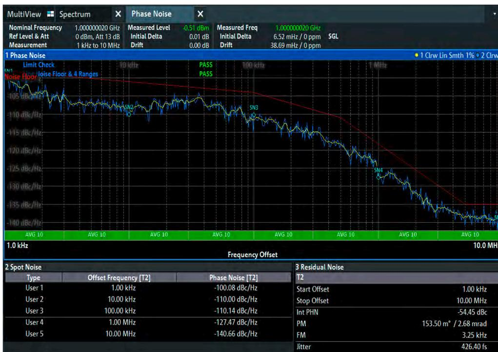
相位雜訊量測、自動限值檢查、點雜訊和殘餘雜訊指示
