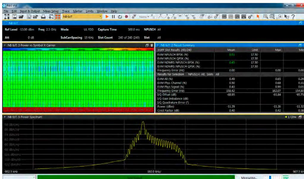
使用 R&S®VSE-K106 量測應用的 NB-IoT 上行鏈路訊號解調和 EVM 量測
