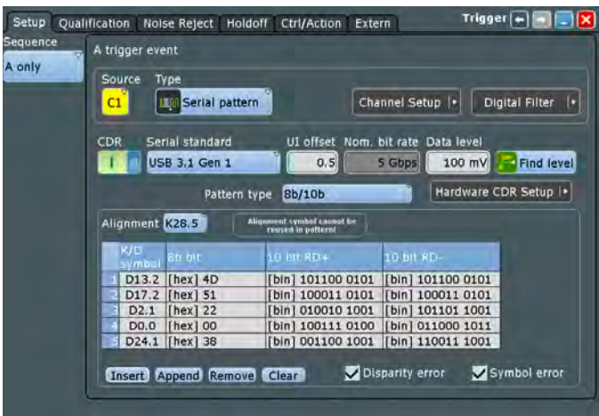
高速串行码型触发的设置对话框
