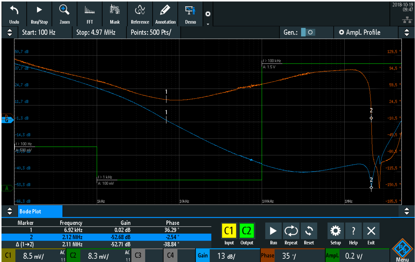
R&S®RTM-K36 频率响应分析（波特图）选件可以测定多种电子设备的频率响应，包括无源滤波器和放大器电路
