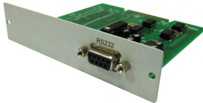
圖 2-3 3350G 系列高功率電子負載 RS232 介面
