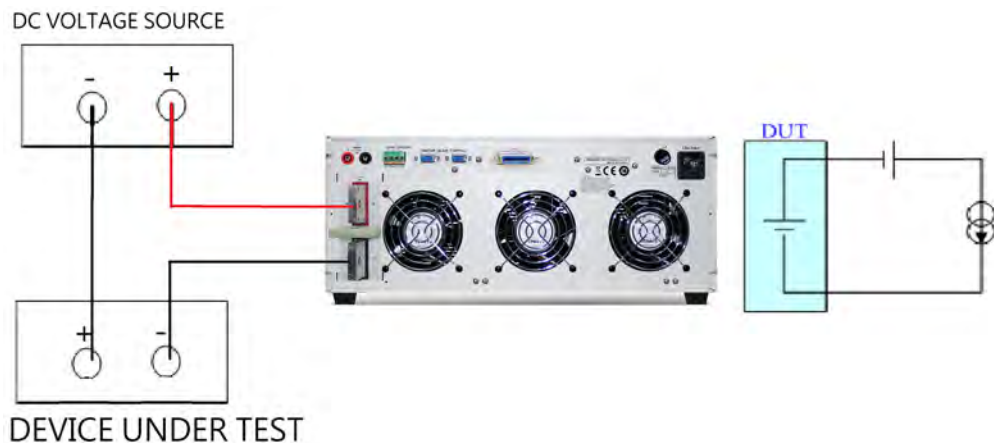
圖 5-11 高功率電子負載最低工作電壓為 0V 時的連接圖
