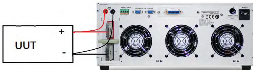
圖 3-2 典型 3350G 系列高功率電子負載連接方式
