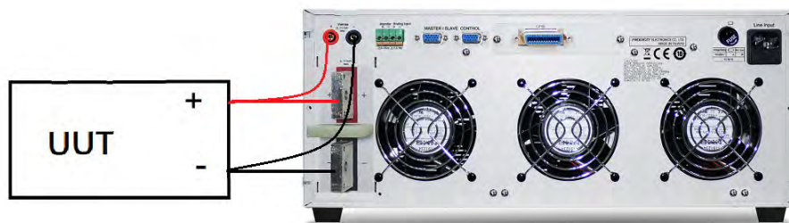
圖 5-2 遠地電壓檢知連接圖
