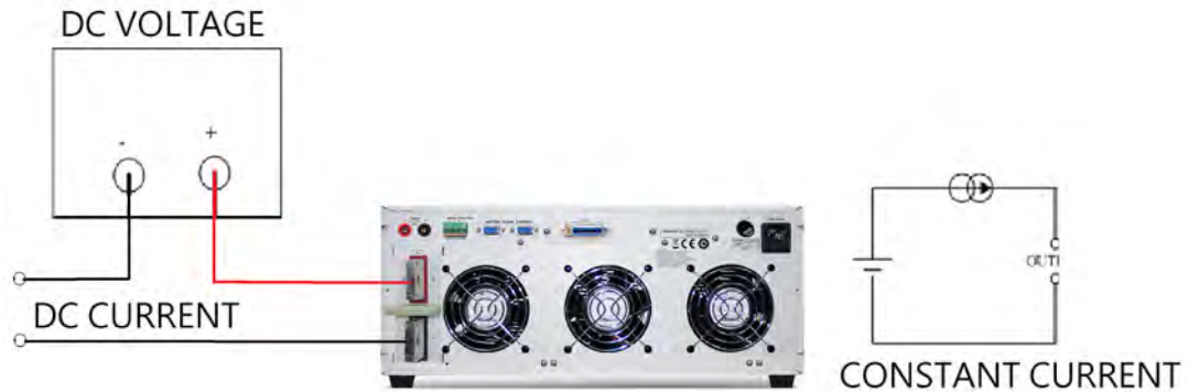
圖 5-10 固定電流源之連接圖
