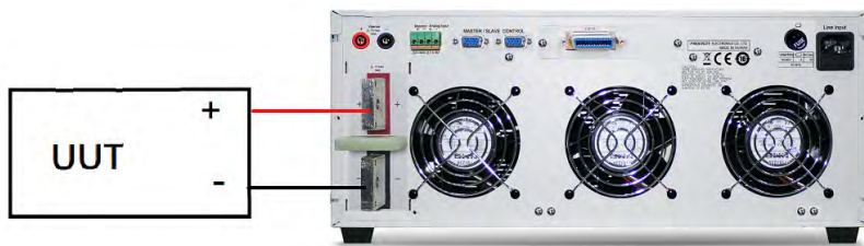
圖 5-1 本地電壓檢知連接圖
