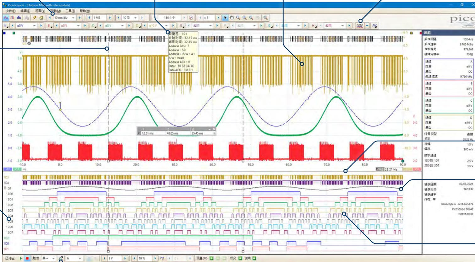
**切分显示屏:** PicoScope 可同时显示模拟与数字信号。可通过调节切分显示屏为模拟波形提供一定空间。
