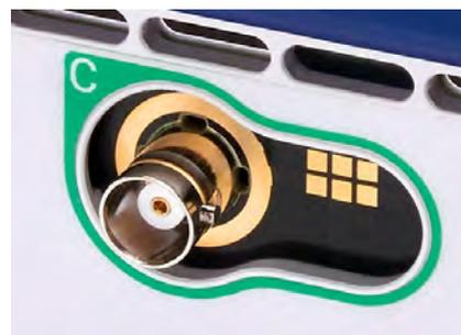
使用 8 通道型号上通道 C 至 F 和 4 通道型号上所有通道的智能探针接口, PicoScope 6000E 系列可支持具有超薄机械设计的创新型有源探针, 从而实现简便的连接和测试中的设备的低负载。
