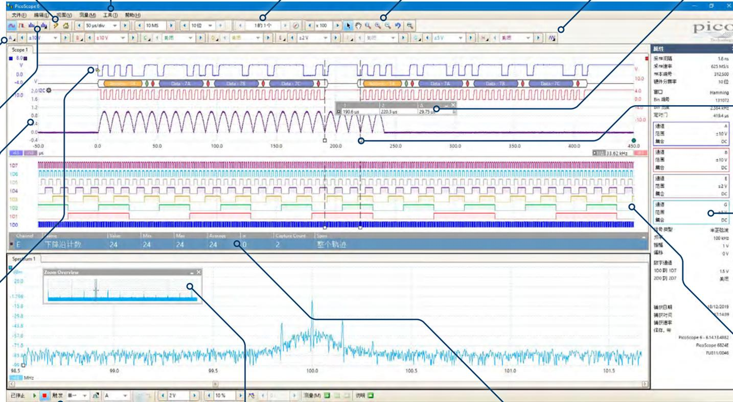
**标尺:**每个轴有两个标尺,可将其拖至屏幕上以快速测量振幅、时间与频率。
