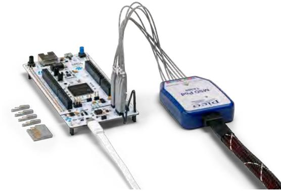
连接到测试中的设备的数字通道
