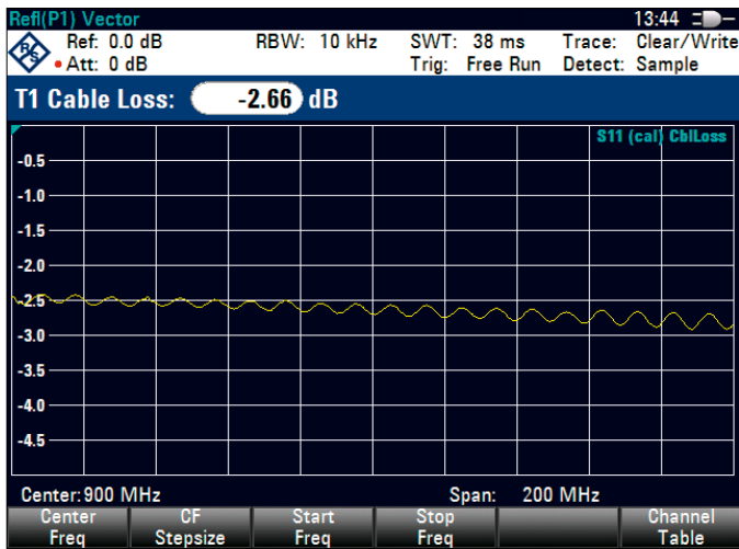
单端口电缆损耗测量
