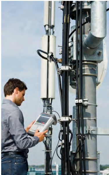
使用R&S®ZVH对移动无线天线系统执行故障点距离测量
