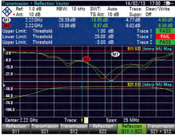
矢量网络分析仪: 同时显示四个参数 (S 11 、S 21 、S 12 、S 22 )
