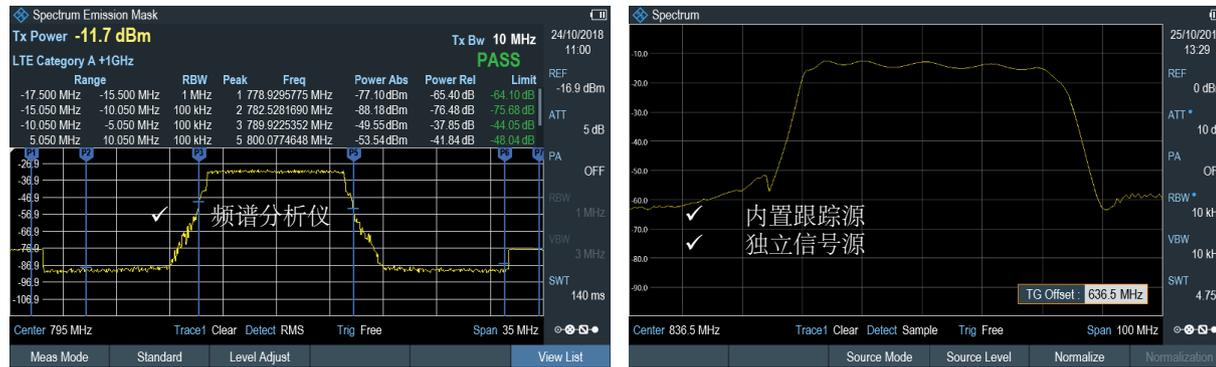
R&S®ZPH-K1支持频谱分析，具有内置跟踪发生器和独立信号源。作为信号源，R&S®ZPH-K1可以在任何频率产生连续波信号，或者R&S®ZPH-K1可以耦合到中心频率。此功能对于频率转换测量非常有用。
