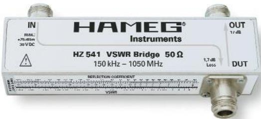
**HZ541 驻波比测量电桥**：配合内置跟踪源的频谱分析仪对天线等被测件进行谐振频率点、回波损耗、反射系数、电压驻波比等与 S11 相关的反射参数进行测量。传统的 S 参数测量使用网络分析仪来进行，但网络分析仪通常价格贵，其普及性和使用频率远不如频谱分析仪。内置跟踪源的频谱分析仪可实现滤波器、线缆、放大器等传输特性的频响测试，使用外置的测量电桥或定向耦合器实现反射特性测试。驻波比桥与频谱分析仪配合构成标量网络分析系统，可对被测件 (DUT) 的端口进行回波损耗、电压驻波比、反射系数等的快速测量，150K~1.05GHz，价格：8500 元
