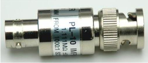
**XFT-75 MC 通过式阻抗匹配器**：75Ω 转 1MΩ 高阻抗，功率 1W，频率 DC~150MHz，¥ 600 元。
