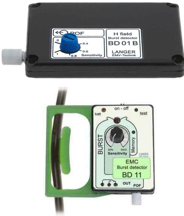
脉冲群探测器可以通过光纤和光接收器连接到示波器。
