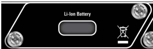
电池盒在 R&S ZNL 中通过普通的交流或直流电源直接充电。电池盒可在 +0 °C 至 +45 °C 的环境温度范围内充电。如温度高于或低于所述值，则充电中断。如电池温度升高到 +53 °C 以上，则充电停止。
