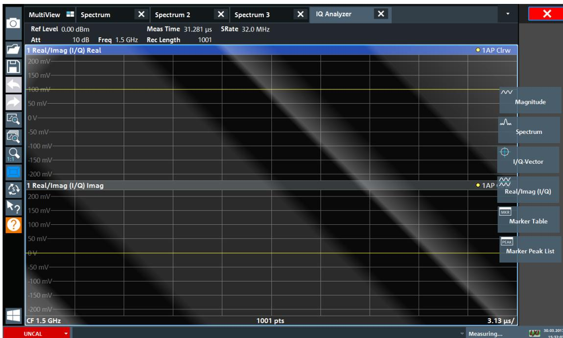
图 6-5: 插入实部/虚部图表，以进行 I/Q 分析
