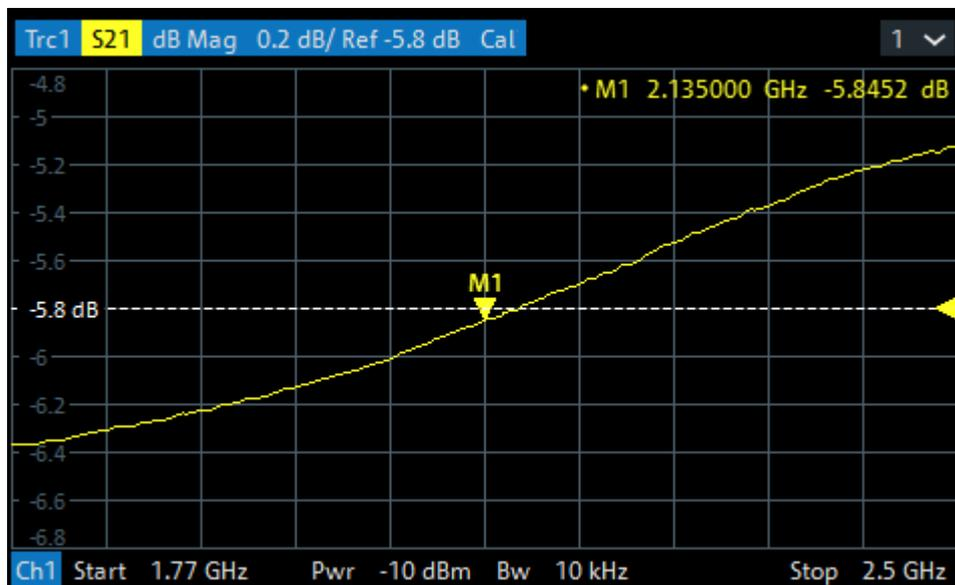
2. 打开 [标记->] > "峰值" 软工具 选项卡，激活 "Min"（最小值）搜索。标记在整个扫描范围内移动到曲线的绝对最小值。标记信息字段显示新标记位置的坐标。
