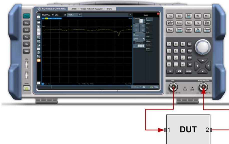
1. 如上所示，将 DUT 连接至网络分析仪的测试端口 1 和 2。
