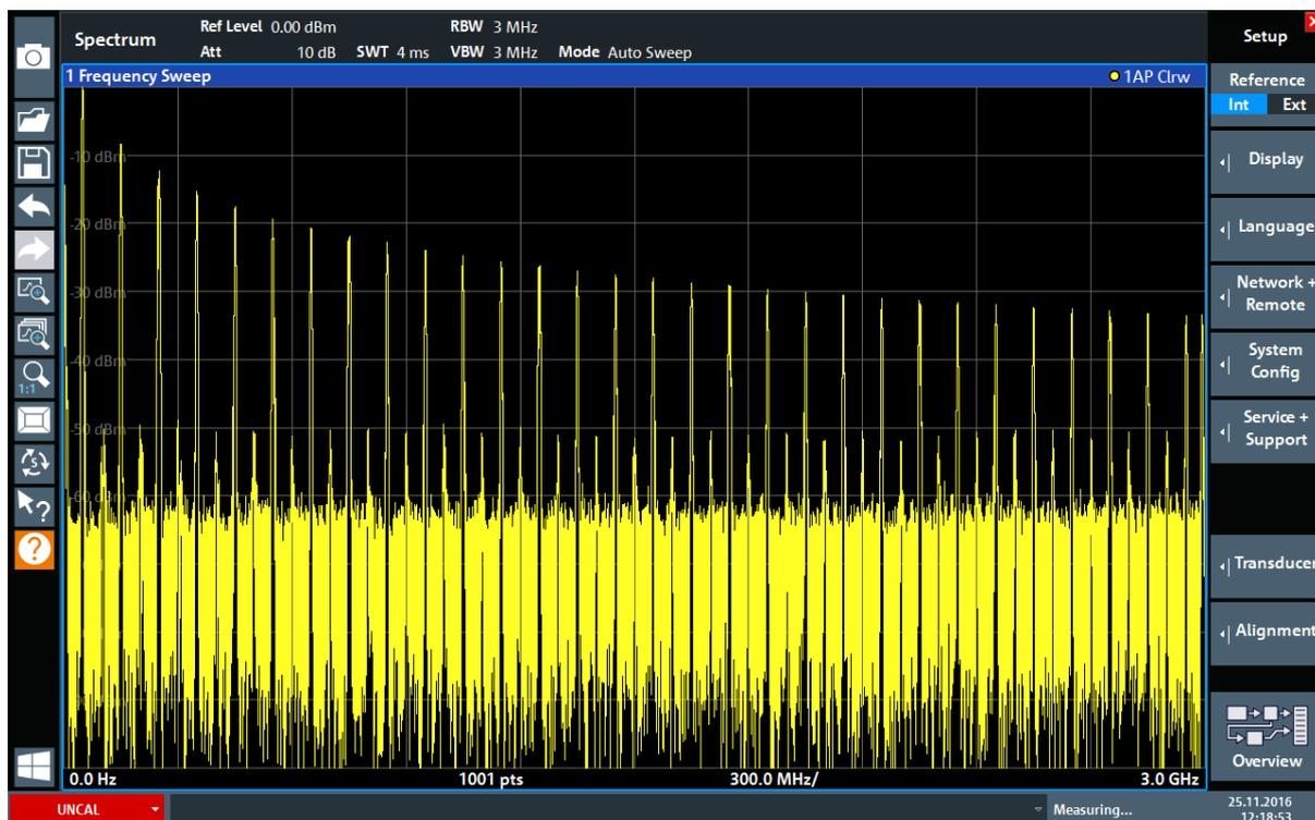
图 6-8: 使用优化后显示设置的校准信号
