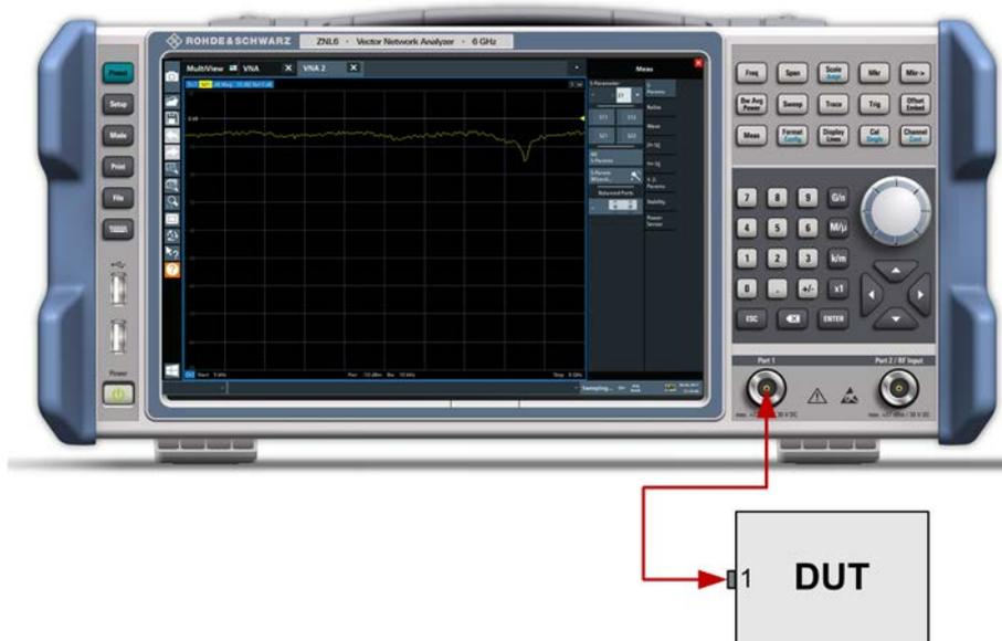
如果您需要并行测量反射和传输参数，也可以使用基本传输测试装置。
