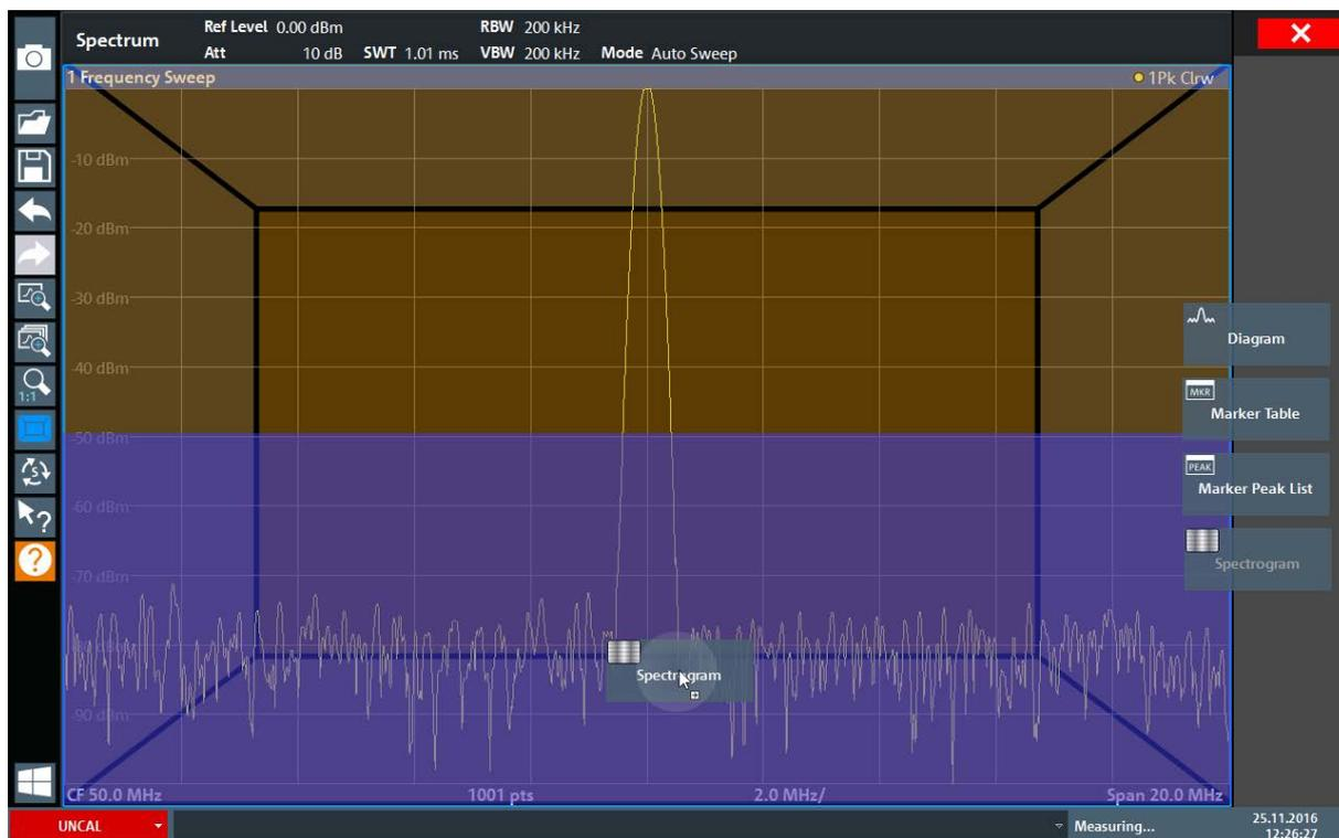
图 6-9: 将瀑布图添加到显示中
