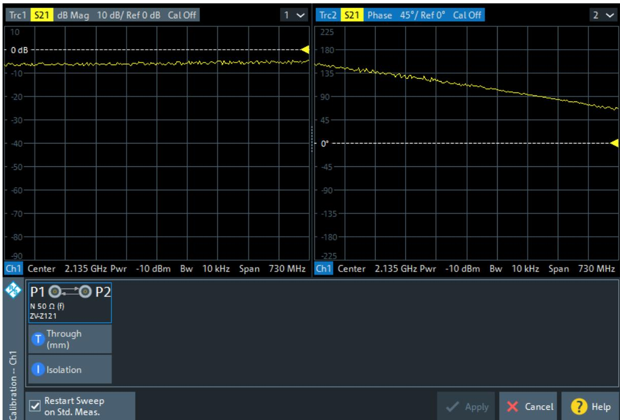
分析仪对被测量  $S_{21}$  执行校准扫描。结果的幅度和相位显示在两个图表中，并包括直通标准件的预期典型测量结果。实际迹线与预期迹线相似，表明直通标准件已正确连接。R&S ZNL 完成校准扫描并计算校正数据之后，启用 "应用" 按钮。
