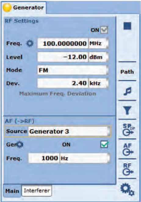
采用内部音频信号源的频率调制。
