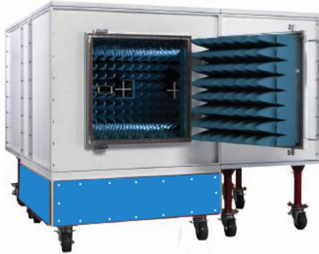
该暗室主要用于 GSM、UMTS、CDMA、蓝牙、DECT 等产品的测试，暗室最低运行频率为 9kHz，暗室采用 3mm 厚铝板焊接而成，重量轻、屏蔽效能好，在 30MHz - 18GHz 的屏蔽效能可达到 100dB 以上，可为无线设备测试提供理想的测试环境。
