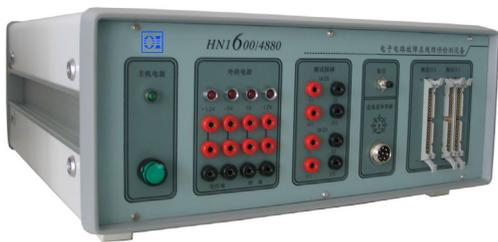
帮助您解除电路板维修中的烦恼，配合电脑使用，全部智能化。利用电脑弥补人工维修能力的不足，在维修人员缺乏图纸资料或不清楚电路板工作原理情况下，对各种类型电路板进行 ASA 分析或 ICT 测试，在线检测元器件好坏，迅速检测出电路板上故障的元器件，实现器件级维修，是一款通用电子电路板故障检测仪器。
