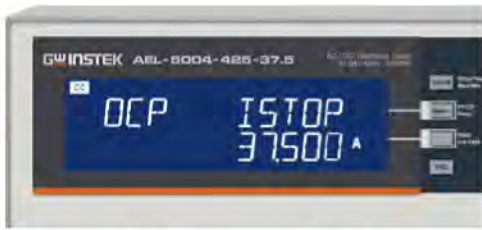
Turbo OFF, OCP Istep 3.75 A Istop 37.5A 测试结果画面
