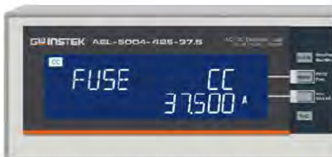
Turbo: OFF, Fuse mode测试结果画面
