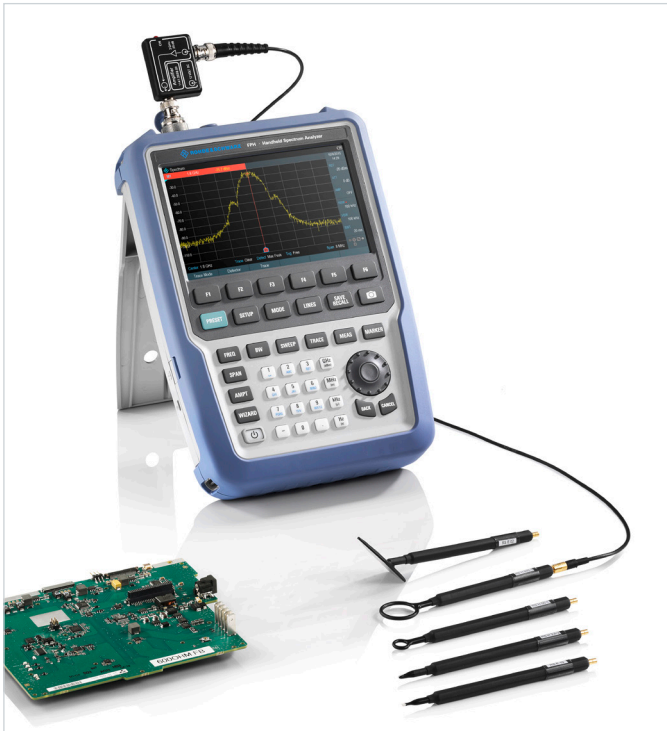
带近场探头的 R&S®Spectrum Rider FPH 和被测设备
