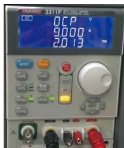
圖9 3311F的BMS過充電流測試結果(連續STEP脈衝)
