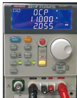
圖14 3311F的BMS過放電流測試結果(連續STEP脈衝)
